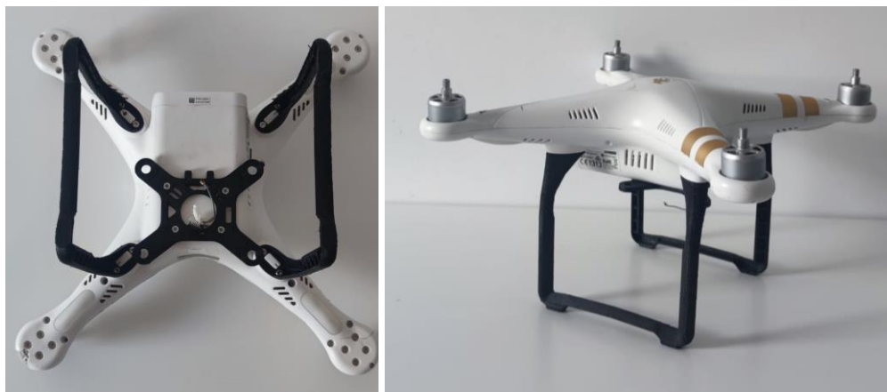
Figura 23 DJI Phantom 3 Pro – drona după asamblarea pieselor reproiectate și refabricate [BLA24B]
