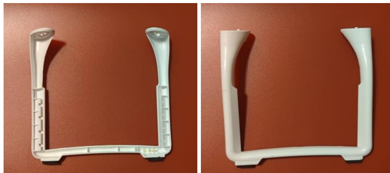
Figura 15 Tren de aterizare DJI Phantom 3 Pro– vedere din interior și din exterior (raportat la modul de montare) [BLA24B]
