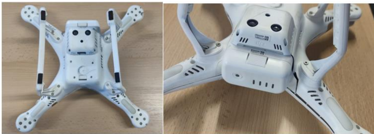
Figura 24 DJI Phantom 3 Pro – test dronă cu piese originale – inspecție vizuală structură după teste [BLA24B]
