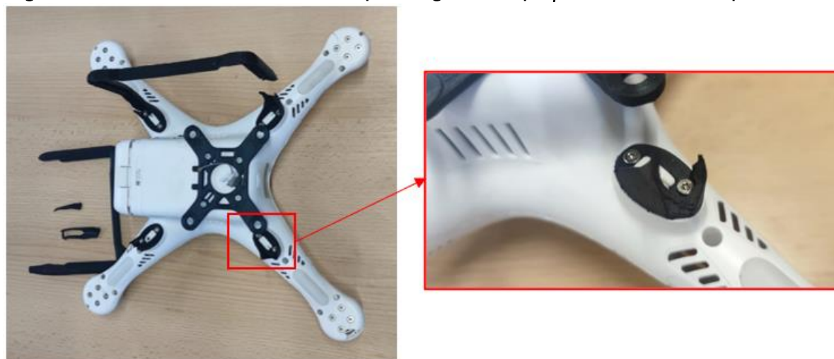
Figura 25 DJI Phantom 3 Pro – test dronă cu piese reproiectate – inspecție vizuală structură după teste [BLA24B]
