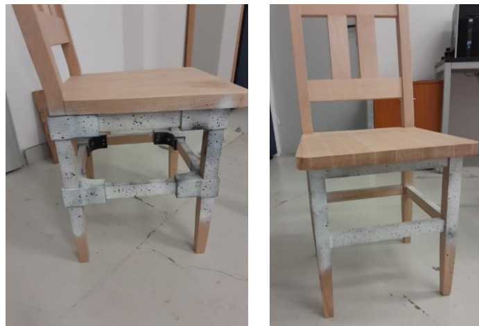
Fig. 39. Pregătirea scaunelor pentru testare: a. scaunul cu conectori; b. scaunul cu îmbinări clasice.
