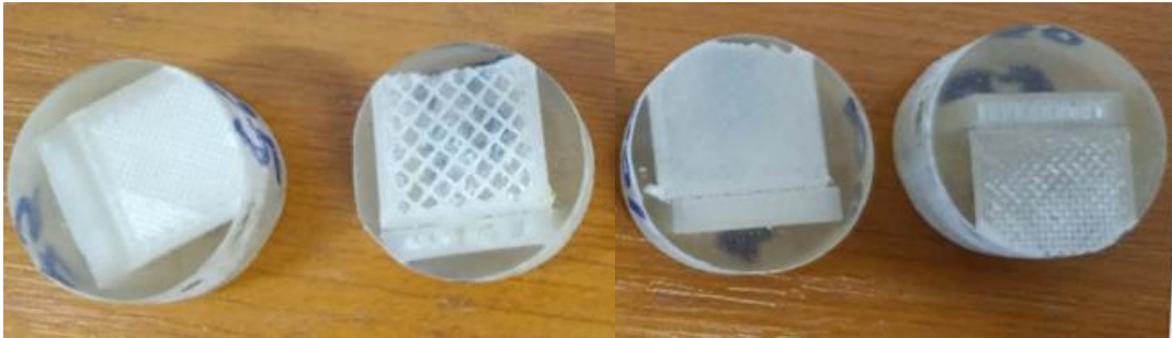
Fig. 12. Mostrele pregătite pentru evaluarea calității suprafețelor imprimate 3D prin metoda FFF, cu filament compozit cu fibre de sticlă (Nicolau et al. , 2022)
