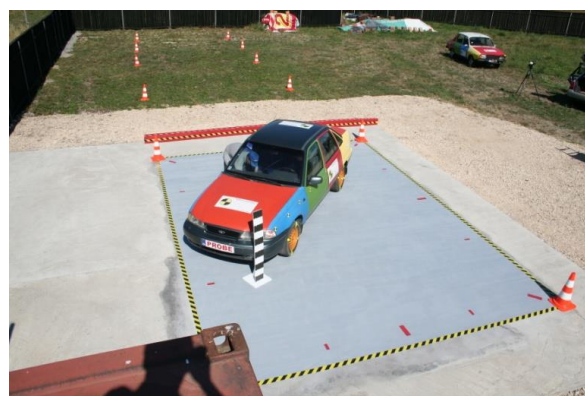
Fig. 5.13 Marcarea platformei de încercări
