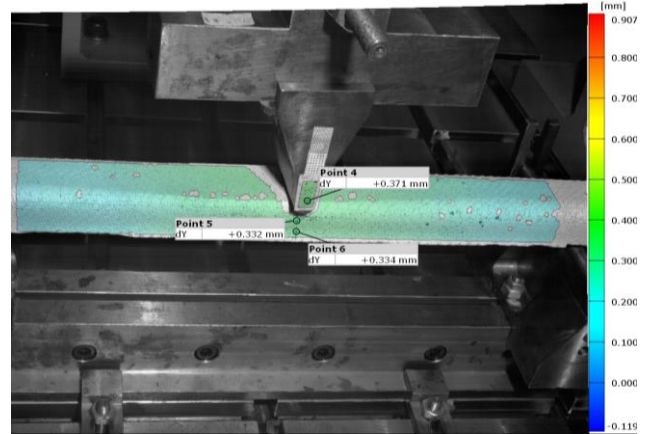
(d) Displacement v = 0,332 mm for F = 312,41 N
