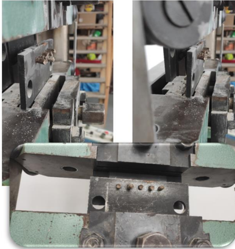
Figura 3.17. Secvențe din timpul determinării rezistenței la forfecare a peleților lignocelulozici
