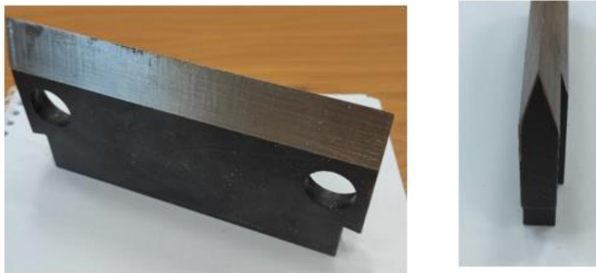
Figura 3.16. Forma plăcii superioare cu un unghi de 65^{\circ}
