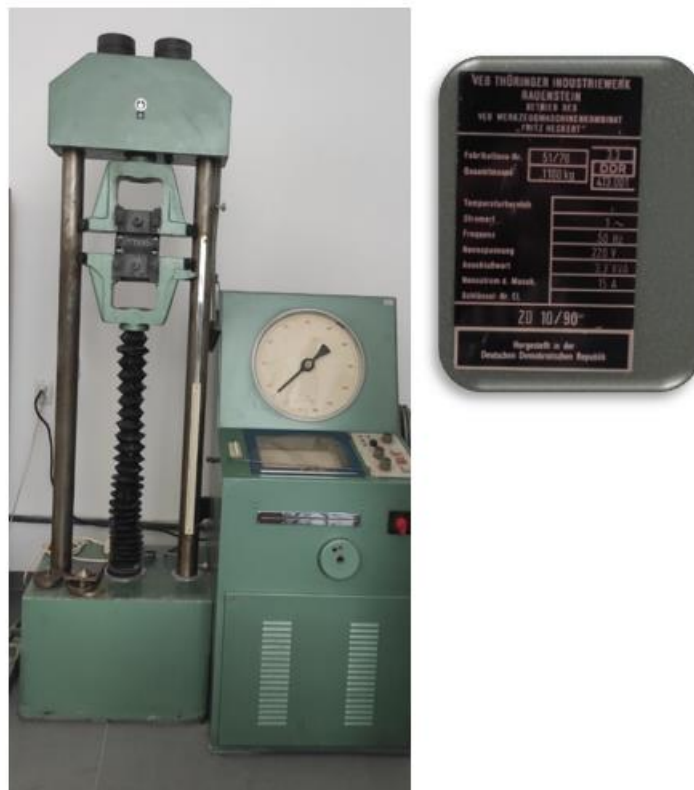
Figura 3.14. Mașina pentru determinarea rezistenței la despicare (de producție germană)
