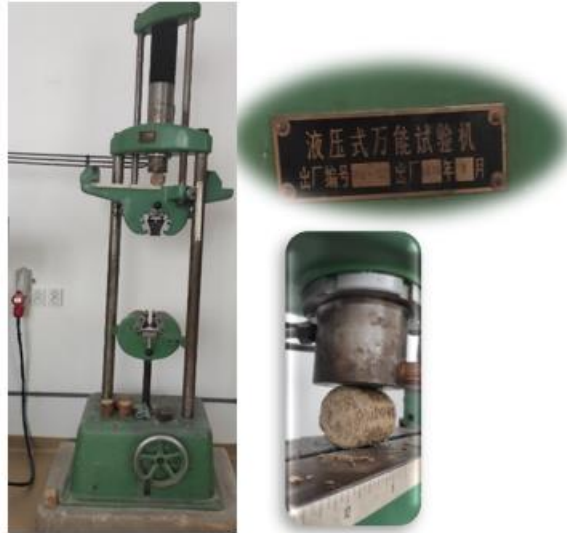
Figura 3.10. Maşina pentru determinarea rezistenței la compresiune (de producție chinezească)
