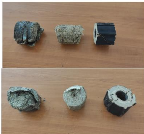
Figura 3.13. Brichete lignocelulozice obținute în urma determinării rezistenței la compresiune
