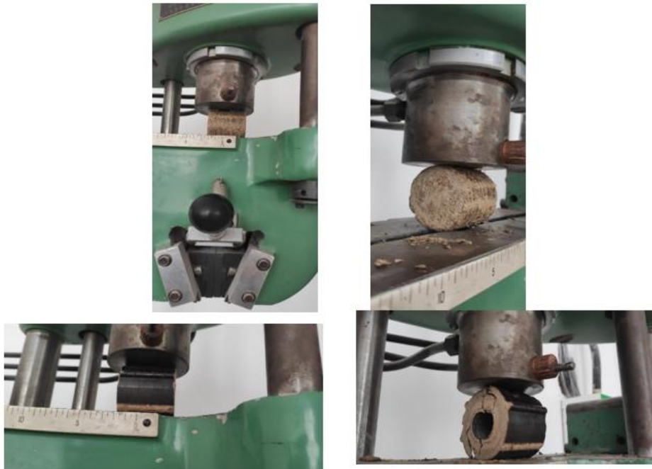
Figura 3.11. Secvențe din timpul determinării rezistenței la compresiune a brichetelor lignocelulozice a- pentru brichete lignocelulozice fără goluri; b - pentru brichete lignocelulozice cu goluri.
