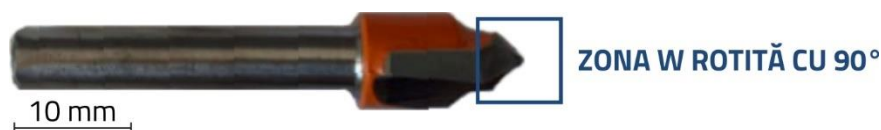
Fig. 4.8. Zona W rotită cu 90° de investigare a uzurii sculei (Lungu et al. , 2021c).
