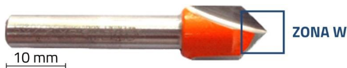
Fig. 4.7. Zona W de investigare a uzurii sculei (Lungu et al. , 2021c).
