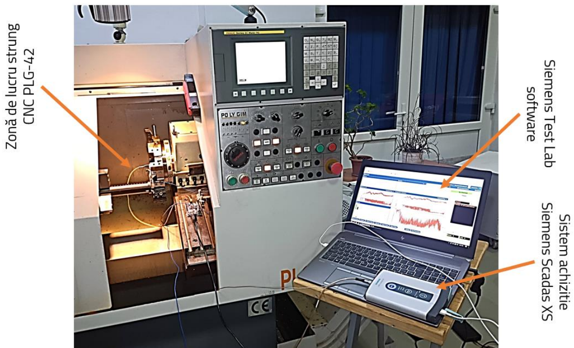
Fig. 4.86 Configurarea generică pentru măsurarea inertențelor punctului generator la strungul CNC PO PY GIM PLG-42
