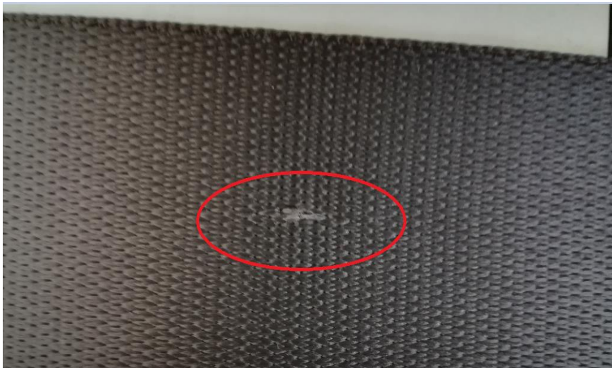
Figura 3.3 Chingă cu urmă de înțepătură în urma ruperii butonului de reținere
