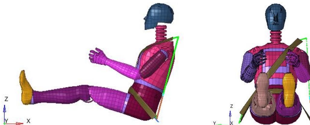
Figura 6.3. Manechinul și sistemul de centură de siguranță (vedere laterală și față - Hybrid III 50th Male FE )
