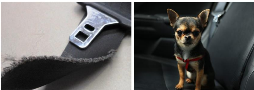
Figura 1.16. Centură cu chingă deteriorată în urma transportului neconform al animalelor
