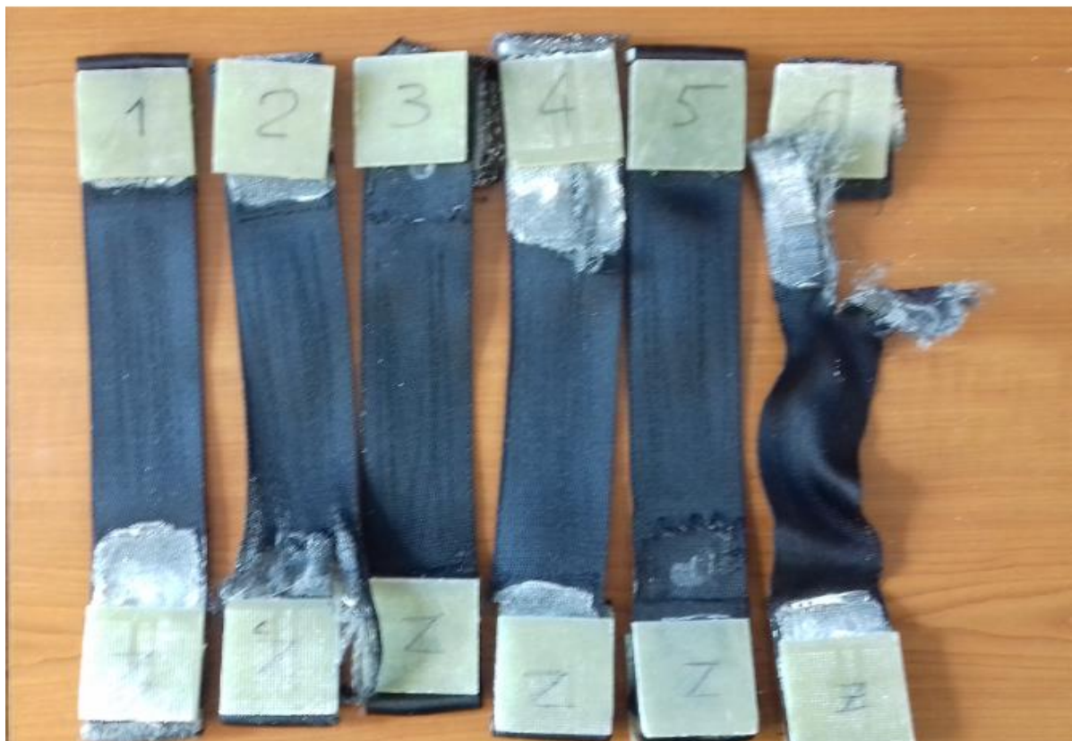
Figura 5.31. Aspectul epruvetelor zgâriate după efectuarea încercării
