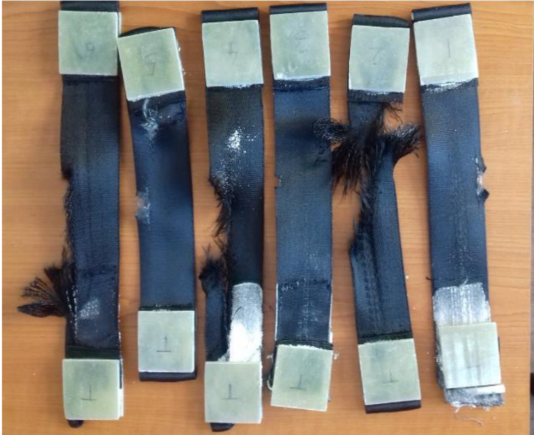
Figura 5.22 Aspectul epruvetelor tăiate după efectuarea încercării
