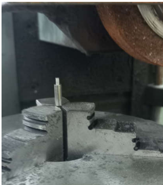
Figura 7.5. Dispozitiv pentru fixarea acului pulverizatorului pe mașina de rectificat UMG Cugir
