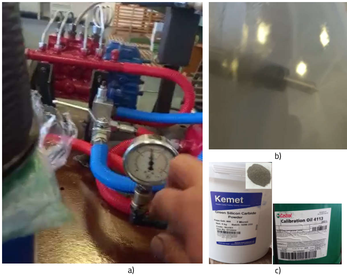
Figura 7.1. Prelucrarea pulverizatoarelor de injecție : a) - prezentare funcțională; b) - prezentarea pulverizării jetului de combustibil în rezervorul de colectare; c) - prezentare micropulbere SiC - F 800, și ulei de calibrare 4113 utilizate la prelucrare
