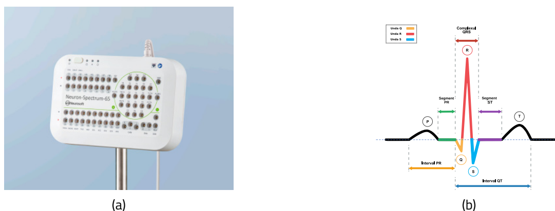
Figura 3.3: Dispozitiv Neuron Spectrum 65, sursă [65] (a), Complex QRS, adaptare după [66] (b).
