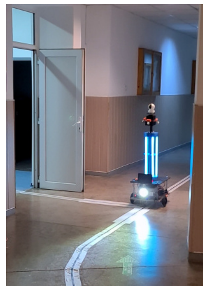
(d) RoboCoV Cleaner folosind marcaje plasate pe podea și cod QR plasat pe ușă pentru a lua decizia la o intersecție a marcajelor.
