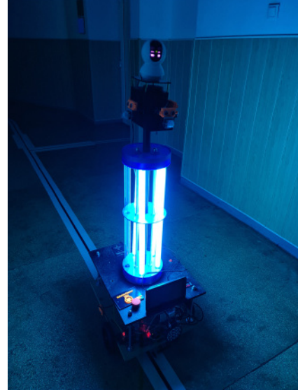
(b) RoboCoV Cleaner folosind marcaje pentru sterilizarea holului Universității Transilvania din Brașov, 2021.
