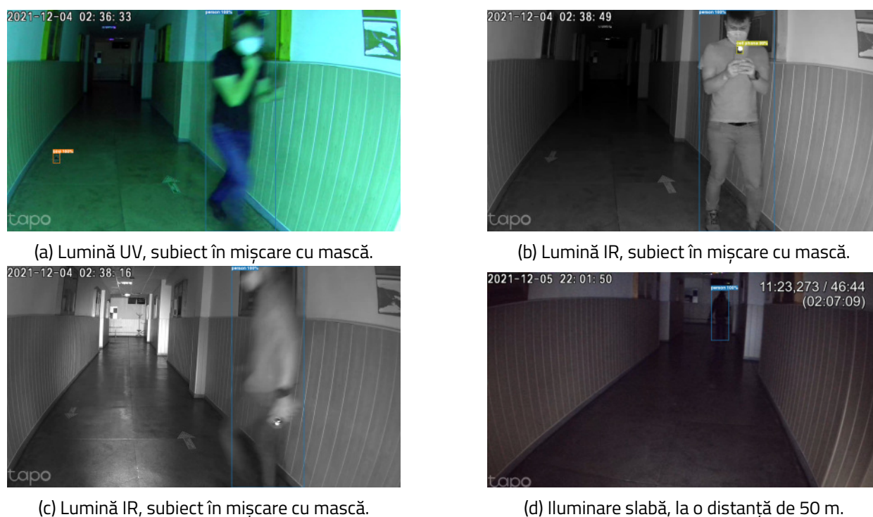
Figura 4.13: Sistemul de detecție în condiții speciale.
