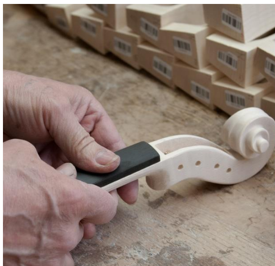
Fig. 3.51. Fixarea limbii pe talpa gâtului
