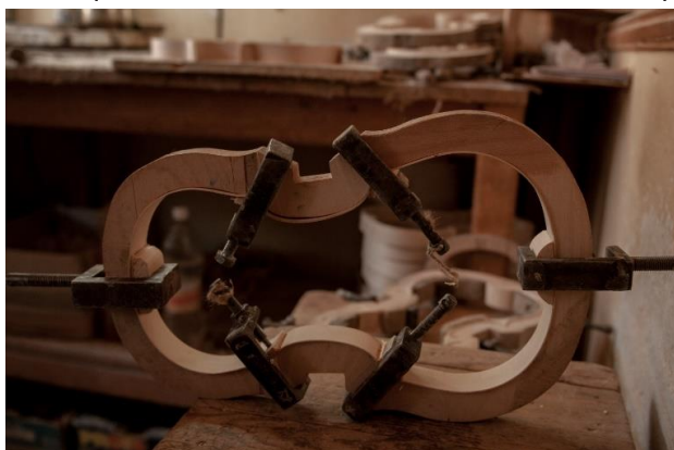
Fig. 3.33. Şablon pentru confecționarea ecliselor
