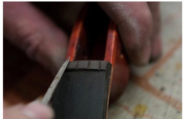
Fig. 3.80. Executarea locașului pentru corzi
