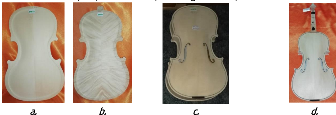
Fig. 5.2. Părți de vioară supuse analizei modale: a-placă față; b-placă-spate; c-corp de vioară; d-corp de vioară cu gât
