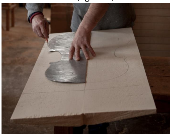
Fig. 3.11. Insemnarea conturului plăcii
