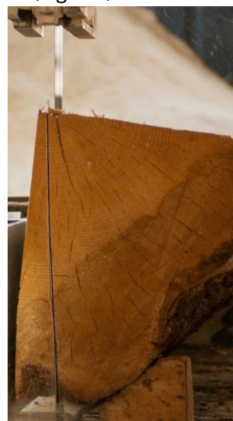
Fig. 3.4. Debitare radială pe ferăstrăul-panglică
