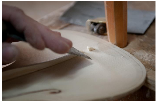
Fig. 3.26. Teșirea canturilor barei de rezonanță
