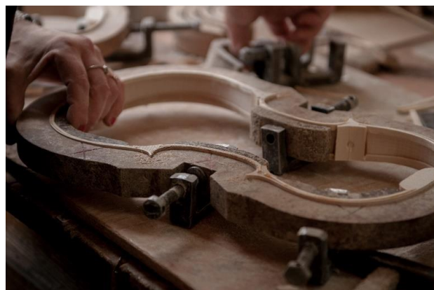
Fig. 3.34. Prinderea și presarea contraecliselor cu contraşabloane
