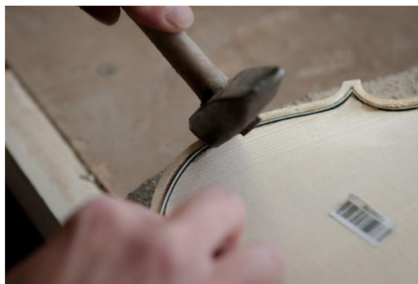
Fig. 3.44. Introducerea fileului în locaş
