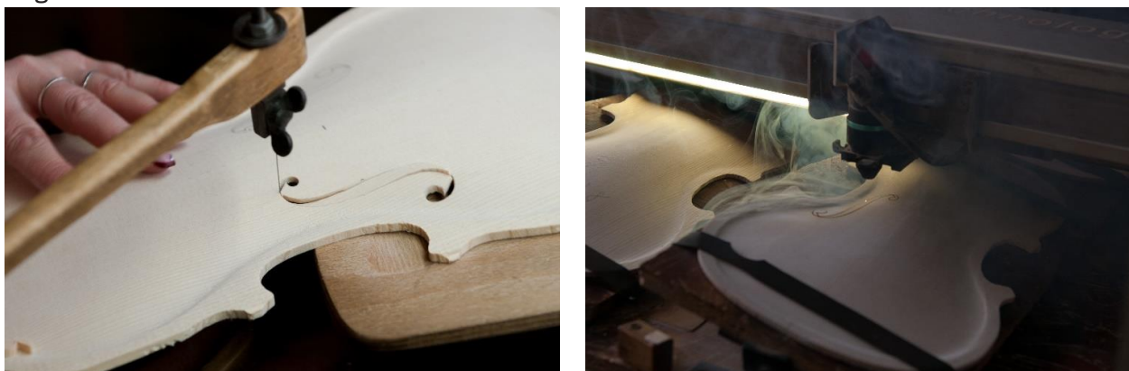
a. b. Fig. 3.24. Tăierea f -urilor: a – cu pânză de traforaj; b – cu rază laser
