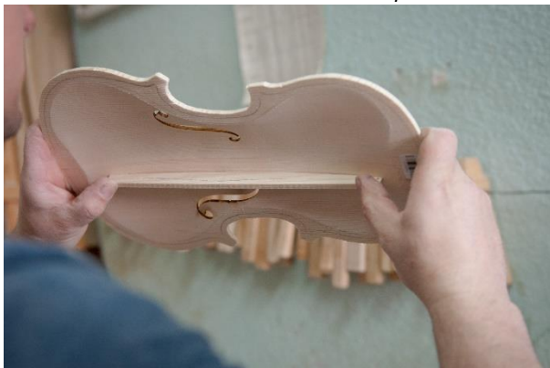
Fig. 3.25. Aplicarea barei de rezonanță pe spatele plăcii-față
