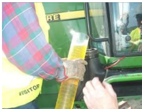
Fig. 2.12 Cilindru gradat destinat determinării consumului de combustibil
