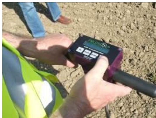
Fig. 2.10 Aparat utilizat la determinarea compactităţii solului SC 900
