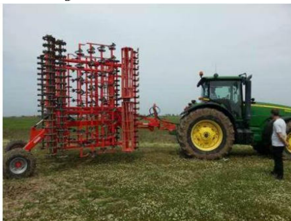
Fig. 2.2 Model vibrocombinator Sandokan 2 în agregat cu tractorul JD 8530 (Sursa: original)
