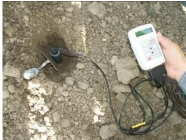
Fig. 2.11 Aparat utilizat la determinarea umidităţii și temperaturii solului Hh2
