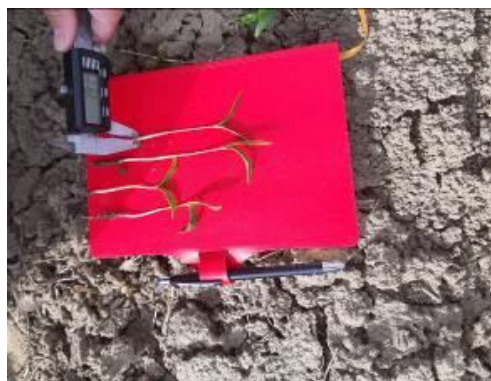
Fig. 2.13 Şublerul digital Kraft K610676 utilizat pentru măsurarea diametrului la colet a puietilor
