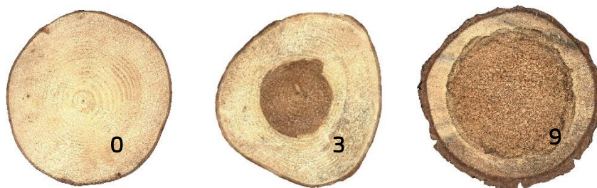
Figura 4.3. Valori indicate de dispozitivul Rotfinder® și proporția lemnului afectat de putregai de rădăcină
