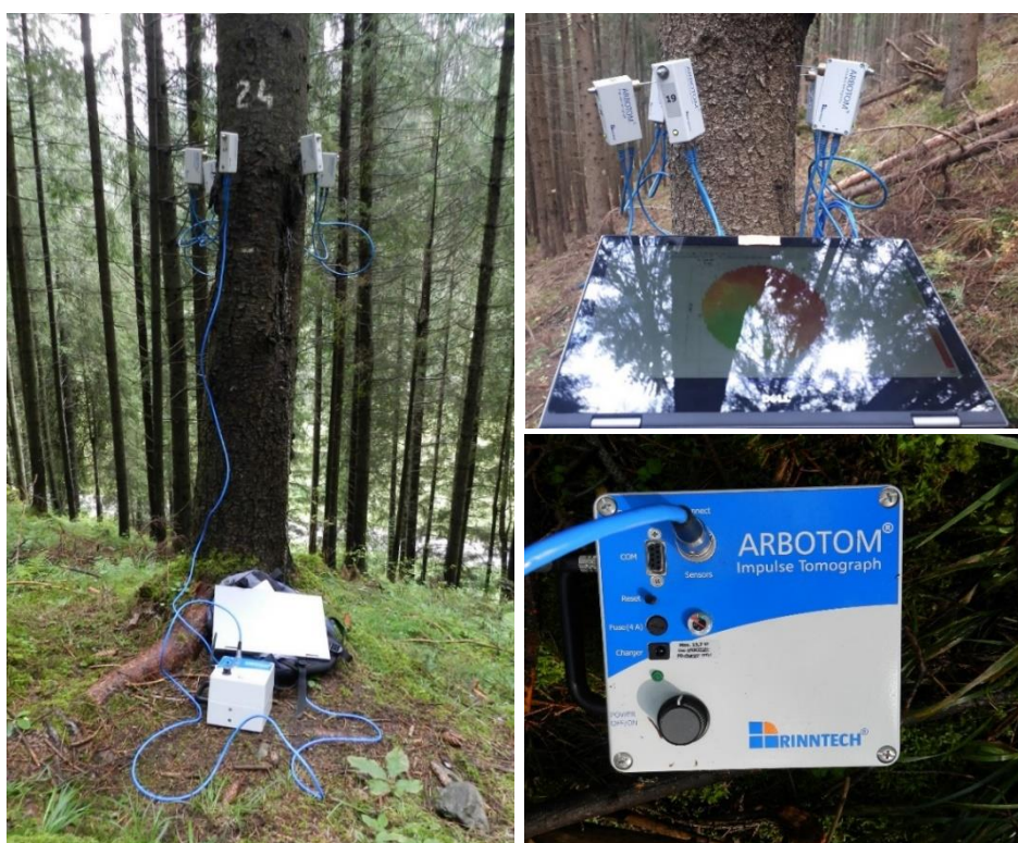
Figura 4.5. Realizarea evaluărilor calitative cu ajutorul tomografului acustic ARBOTOM®
