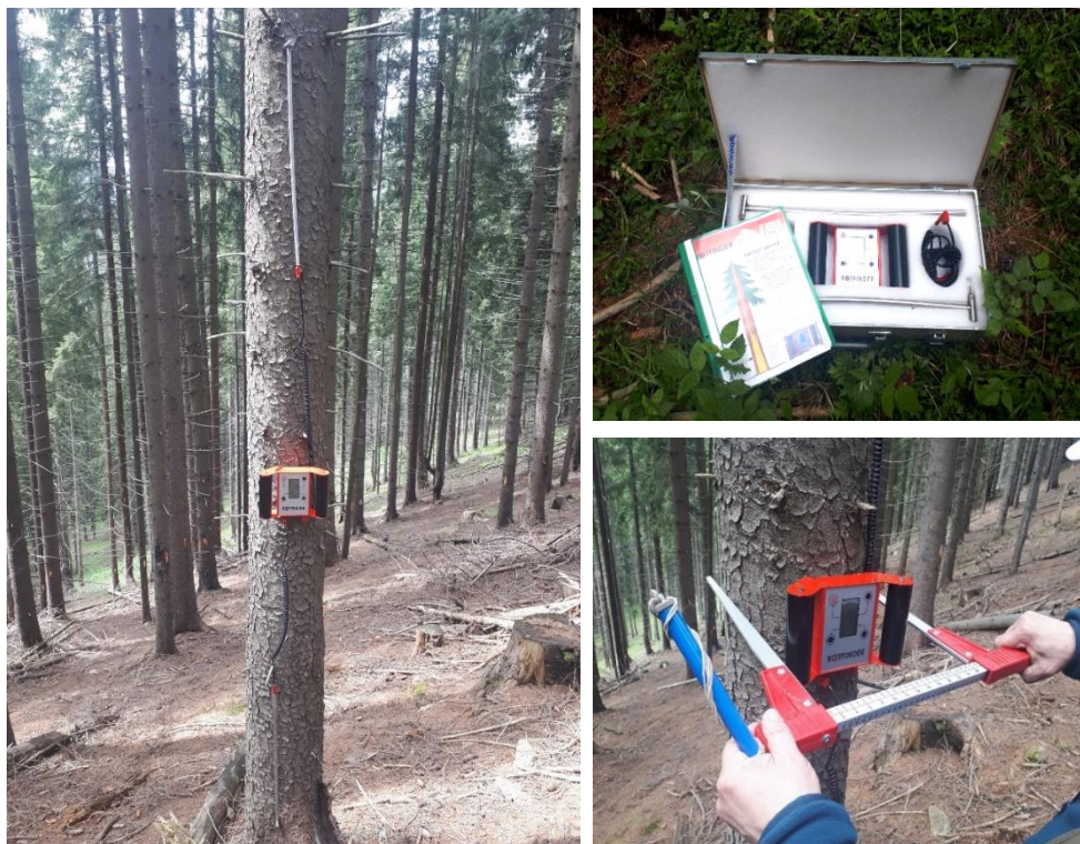
Figura 4.2. Dispozitivul Rotfinder® și modul de utilizare pentru identificarea prezenței putregaiului de rădăcină
