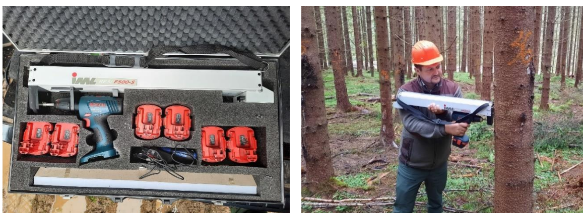
Figura 4.4. Măsurarea rezistenței la micro-foraj cu aparatul IML Resistograph® la arborii de molid cu putregai
