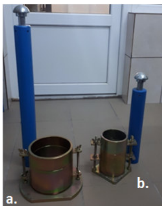
Figura 3.18. Aparat Proctor manual, pentru determinarea capacității de compactare a materialelor: a. tipar Proctor modificat \varnothing 150\text{mm} și mai de compactare Proctor modificat; b. tipar Proctor standard \varnothing 100\text{mm} și mai de compactare Proctor normal
