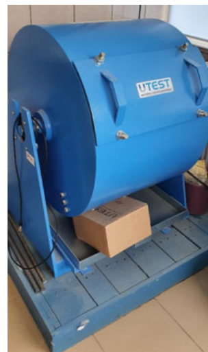
Figura 3.13. Maşina Los Angeles, utilizată pentru a determina rezistenţa la sfărâmare a agregatelor
