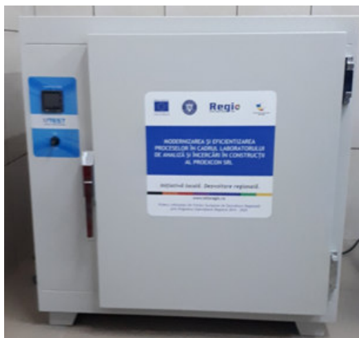
Figura 3.12. Etuvă cu temperatura reglabilă pentru uscarea materialelor
