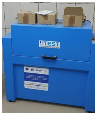
Figura 3.14. Mașina micro-Deval, utilizată pentru a determina rezistența la uzură a agregatelor (Laboratorul de analize și încercări în construcții – gradul II: S.C. Proexcon S.R.L. Onești)
