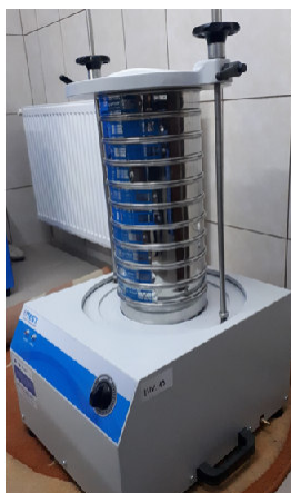
Figura 3.10. Site granulometrice și aparat de sitat pentru cernerea materialelor (site cu ochiuri pătrate, între 63 și 0,063 mm)
