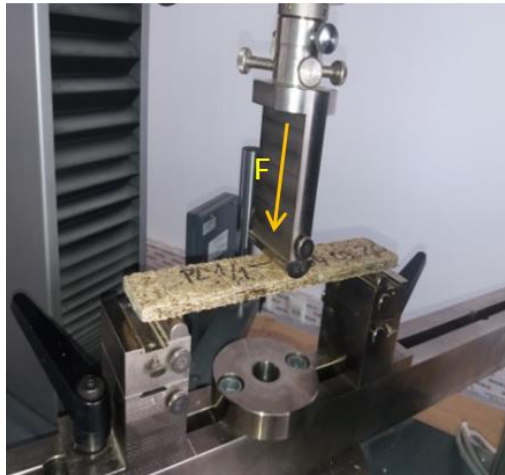
Fig. 5. Testul rezistenţei la încovoiere
