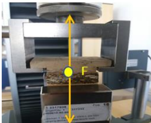
Fig. 6 Modul de testare pentru determinarea coeziunii interne
