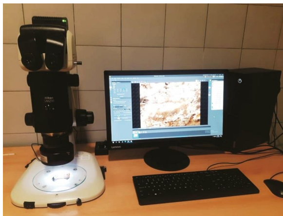
Fig. 8. NIKON SMZ 18-LOT2 Stereo-microscop utilizat pentru analiza microscopică a panourilor
