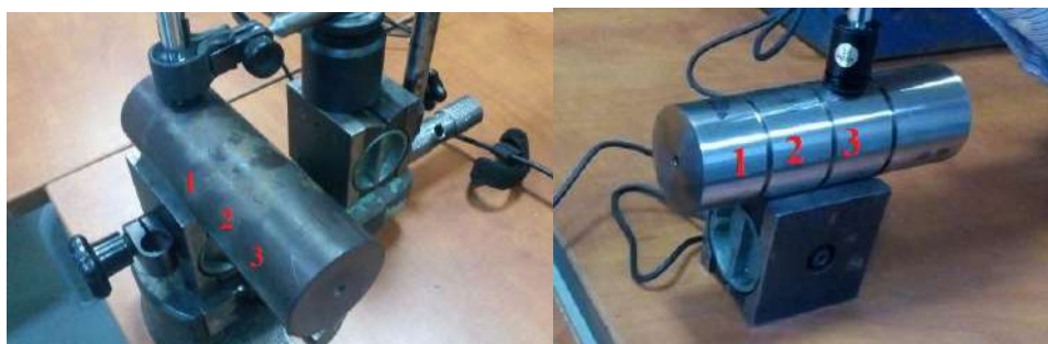
Fig. 7.7- Măsurarea durității în 3 puncte
