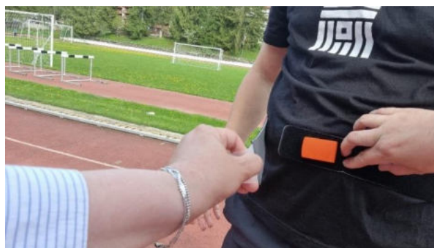
Fig. 111 – Amplasarea senzorului Xsens pe subiect
