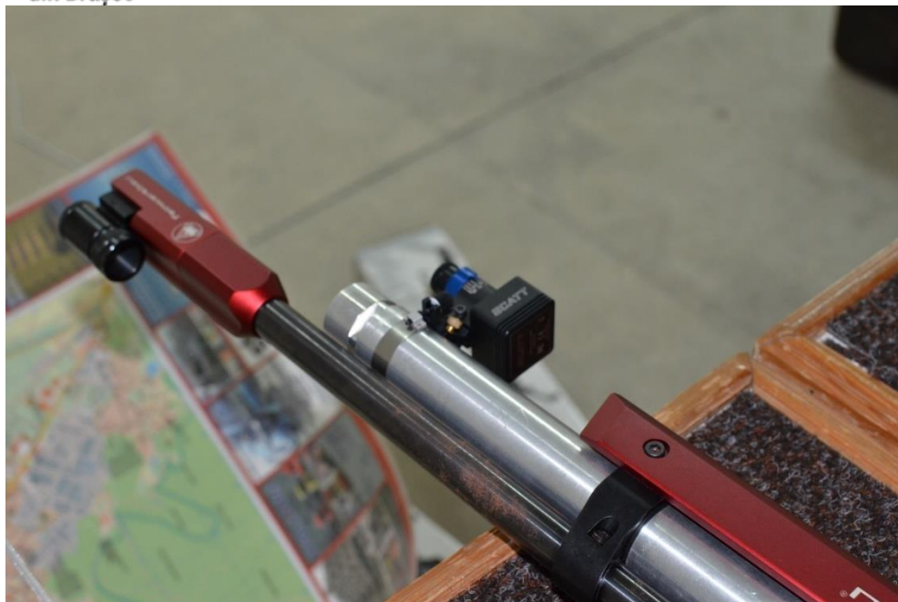
Figura nr.55 Senzorul Scatt ataşat armei de biatlon
