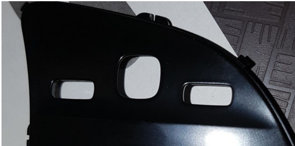
Fig. 8.9 Piesă plastic injectată 2K vopsită cu grund negru
