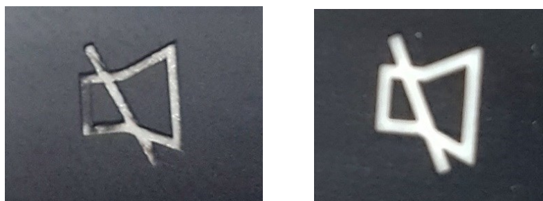
Fig. 7.28 a) Gravare incompletă; b) Lățime mare simbol
