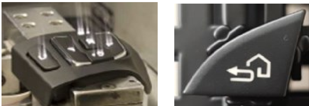
Fig. 7.27 a) Procesul de gravare; b) Simbol după gravare
