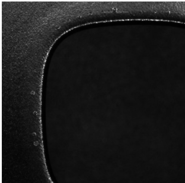
Fig. 8.10 a) Defecte de tip „ochi-de-pește”
