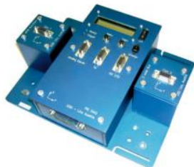
Fig. 5.5 - Sistemul de achiziție de date PicDAQ (Burg et. al, 2017)
