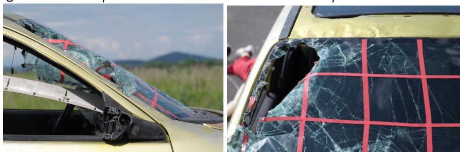
Fig. 8.8. Zona perforată a parbrizului rezultată din experimentul VBM
