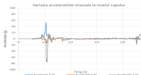
Fig. 6.18 – Variația accelerațiilor triaxiale la nivelul capului M.A.T. - VBE
