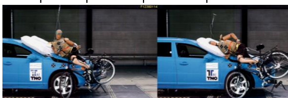
Fig. 1.12 - Principiul de funcționare al airbagurilor externe (Rodarius, 2008)
