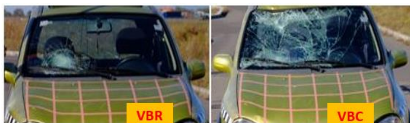
Fig. 7.6. Poziționarea zonei impactului parbriz-cap manechin și distanța de înfășurare (WAD)
