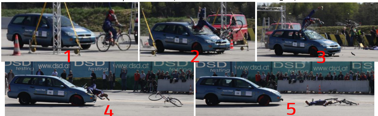
Fig. 6.22 - Etapele dinamice succesive ale experimentului DSD
