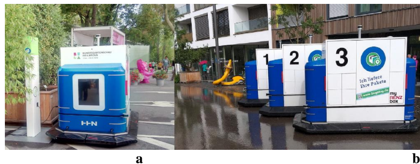
Fig. 7.22 Vehicul autonom: a – la stația de alimentare; b – în cadrul flotei
