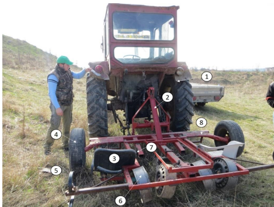
Figura 3. Alcătuirea echipamentului de plantat
