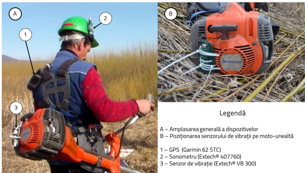
Figura 11. Amplasarea colectoarelor de date
