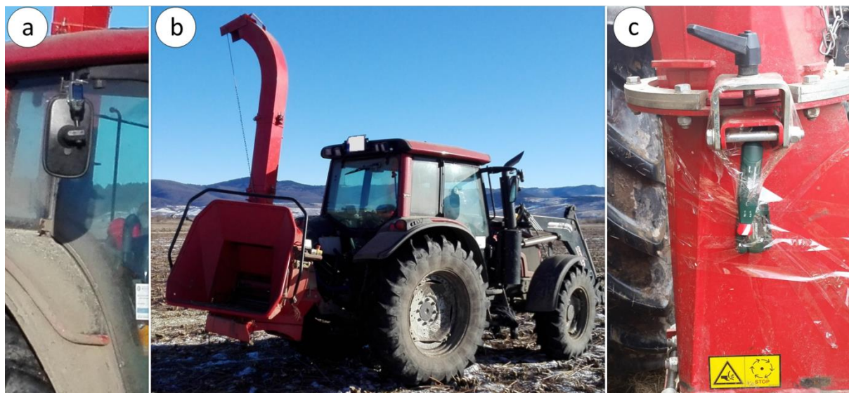
Figura 12. Amplasarea colectorilor de date pe tractor și pe tocător
