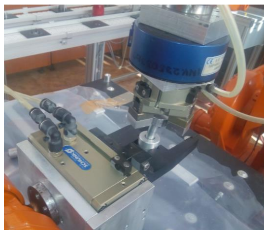
Fig. 7.22 Procesul de asamblare bolț-alezaj cu doi roboți
