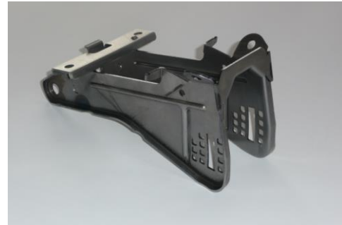
Fig. 7.1 Suport coloană de direcție din oțel
