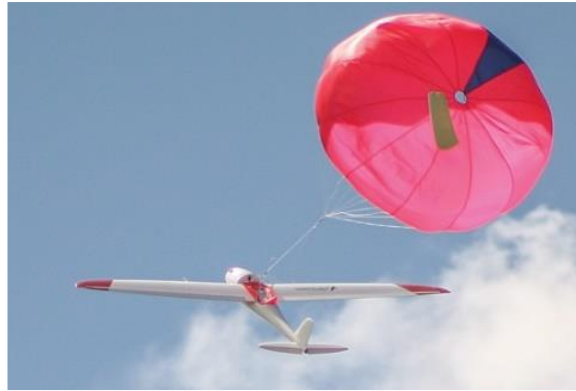
Figura 14 Sisteme de recuperare aeriene cu parașută [ABI2017]
