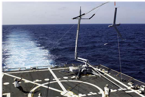
Figura 5 Recuperarea cu cablu de arestare [***010].
