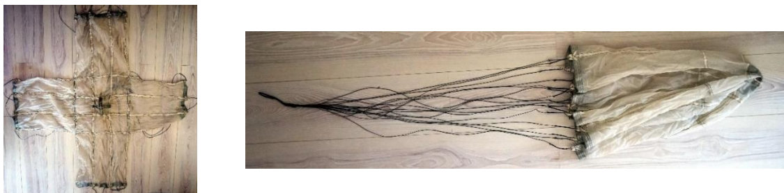
Figura 33 Modelul confecționat al parașutei cruciforme de test
