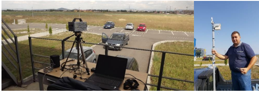
Figura 44 Instalarea camerei de filmare ultrarapidă
