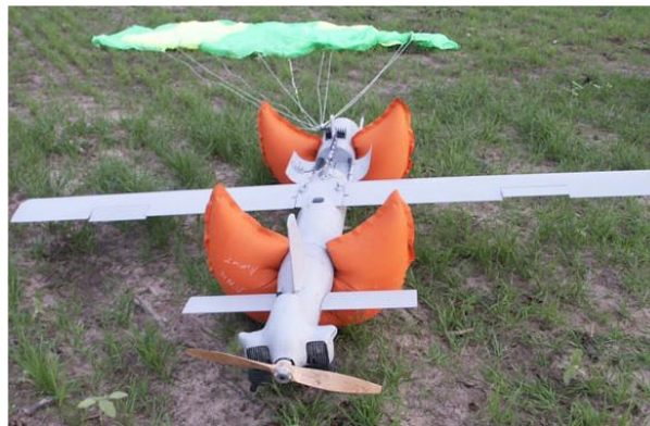
Figura 15 Sisteme de recuperare cu airbag [PPC2016]
