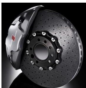
Fig. 1.12 Disc de frână ceramic [61]
