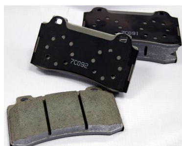
Fig. 1.13 Plăcuțe de frână ceramice [62]
