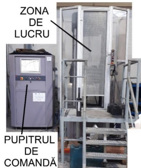
Fig. 6.2 Mașină de testare a rezistenței la tracțiune („MTS” – S.C. Terwa Construction S.R.L.)
