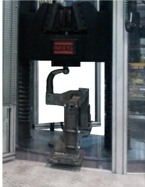
Fig. 8.1-b Sistemul de remorcare fixat pe mașina de testare la tracțiune
