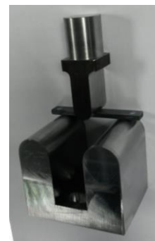
Fig. 6.4 Dispozitiv pentru încercarea epruvetelor la încovoiere
