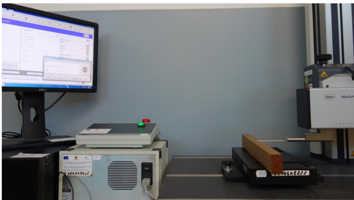
Fig. 5.3. Echipament MarSurf XT20 pentru determinarea rugozității suprafeței prelucrate.
