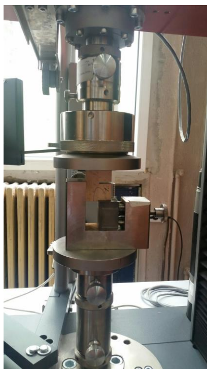
Fig. 5.32. Detaliu al dispozitivului special pentru încercarea la forfecare
