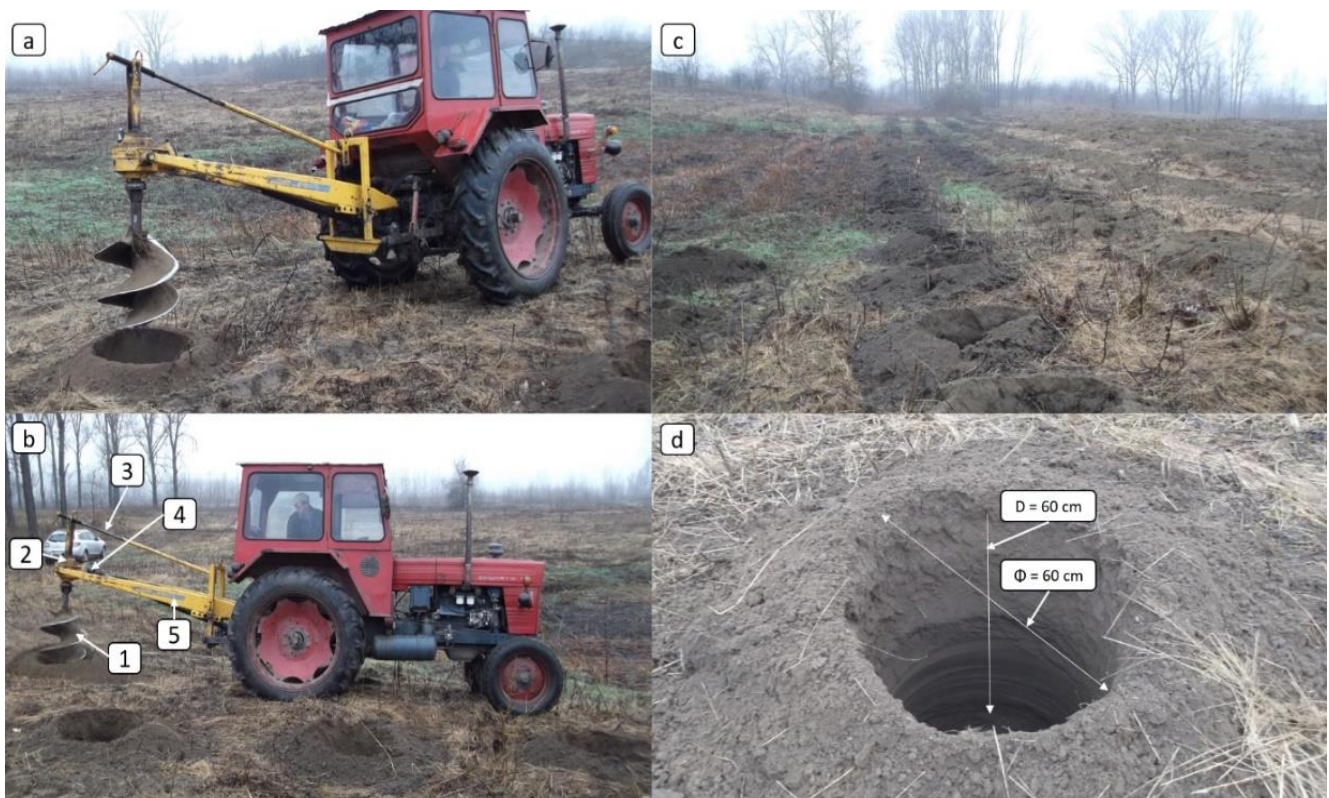
Figura 11. Descrierea de ansamblu a tractorului, echipamentului de săpare precum și a modalității și schemei de săpare a gropilor pentru plantarea puieților de plop
