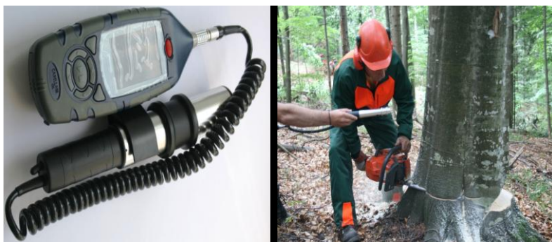
Figura 3.7. Analizor monitorizare pulberi CEL 712 Microdust Pro Casella (Autorul)
