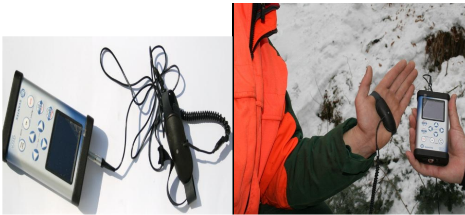
Figura 3.4. Vibrometrul portabil Svantek SV 106 și accelerometrul triaxial SV 105 A (Autorul)
