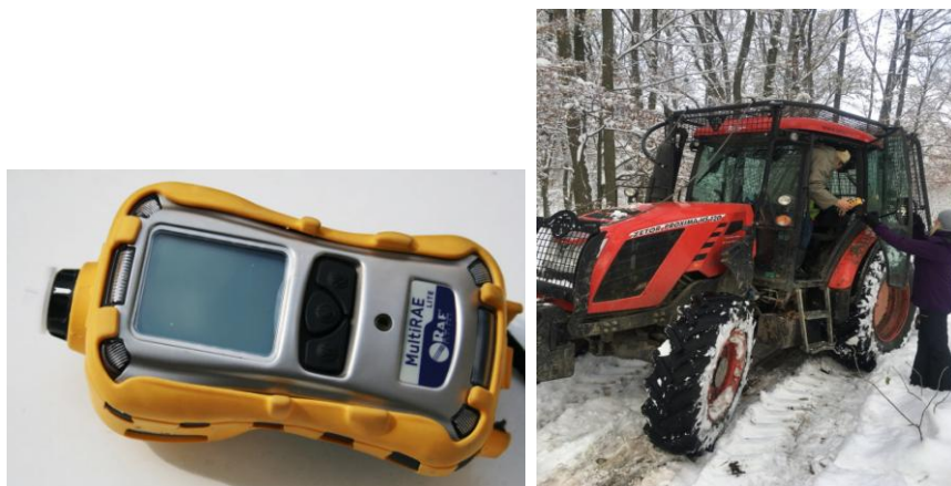
Figura 3.6. Monitor portabil multigaz model Multirae Lite (Autorul)
