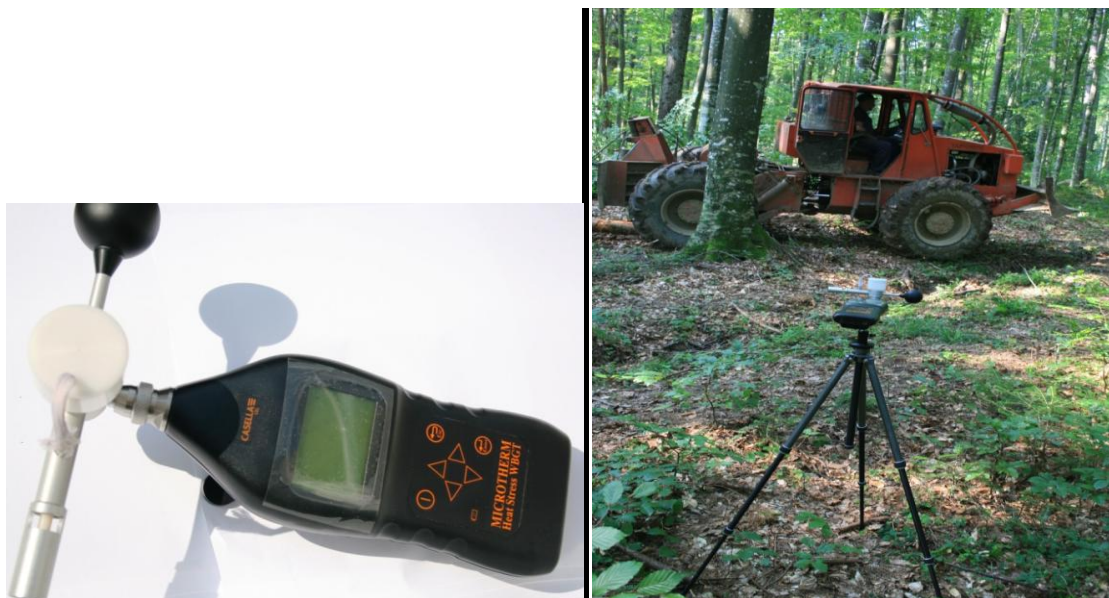
Figura 3.2. Monitorul de stres termic WBGT (Autorul)
