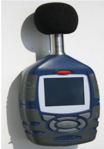
Figura 3.3. Sonometru clasa I cu integrator - Casella Cell 620B (Autorul)
