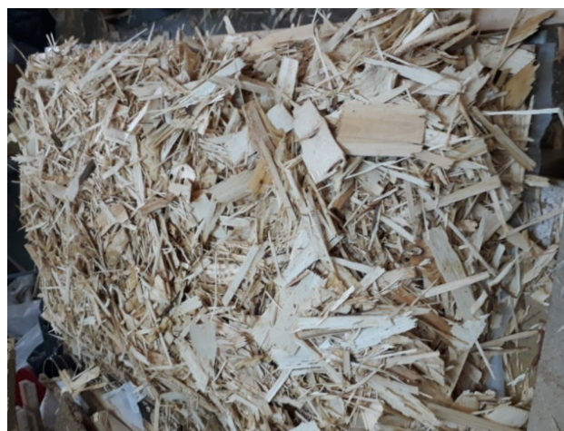
Figura 3.34. Covor de aşchii pregătit pentru presare (Autorul)
