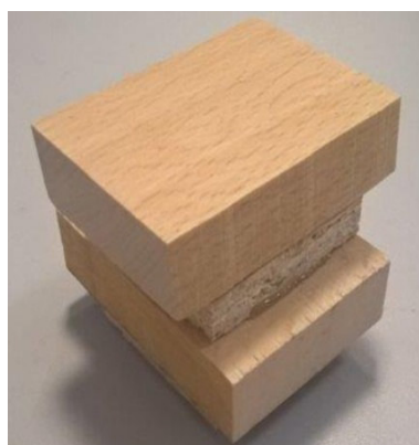
Figura 4.18. Determinarea rezistenţei la coeziune internă transversală (Lunguleasa 2004b)
