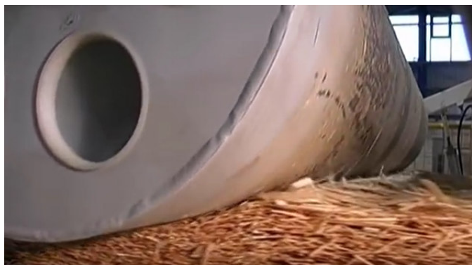
Figura 3.24. Prepresarea covoarelor din aşchii orientate în vederea compactării acestora
