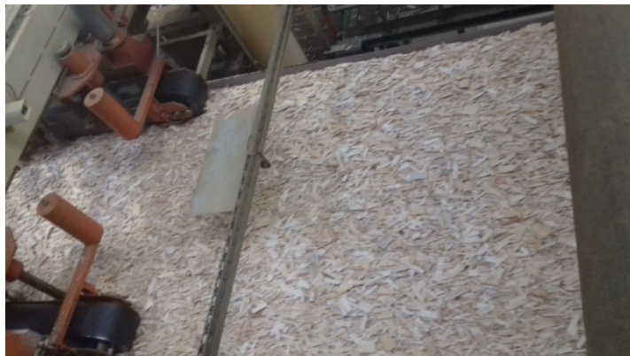
Figura 3.22. Dispozitive de orientare a aşchiilor (Autorul)
