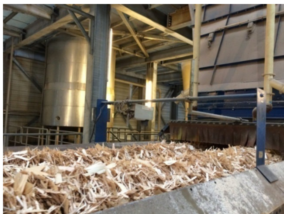
Figura 3.20. Covor de aşchii în cadrul tehnologiei de producere a plăcilor OSB (Autorul)
