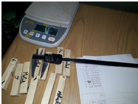
Figura 4.5. Şubler electronic – Laboratorul de Compozite Stratificate (Autorul)
