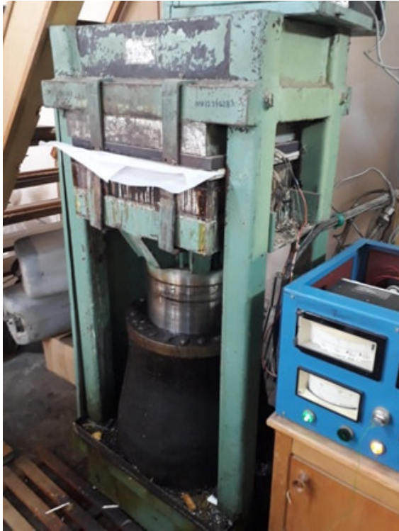
Figura 3.37. Presa hidraulică numărul 2, cu cadre și un singur piston (Autorul)
