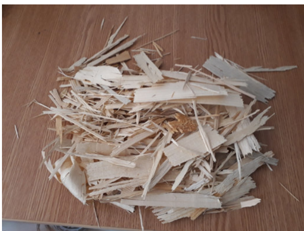
Figura 3.8. Așchii folosite la fabricarea plăcilor OSB (Autorul)
