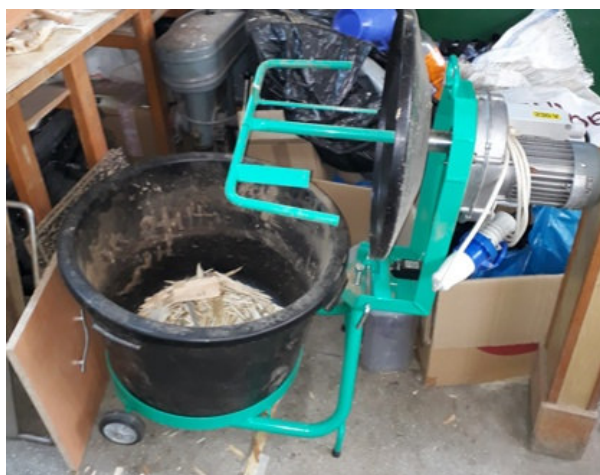
Figura 3.33. Malaxor pentru amestecul aşchiilor cu adezivul în soluție (Autorul)
