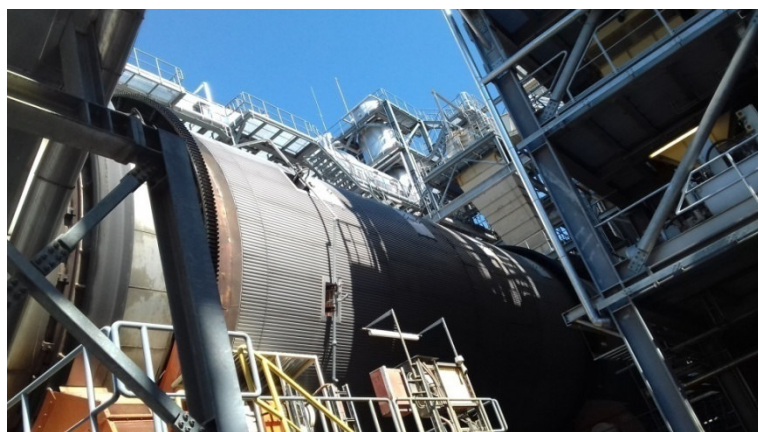
Figura 3.11. Uscătoare rotative înseriate (Autorul)
