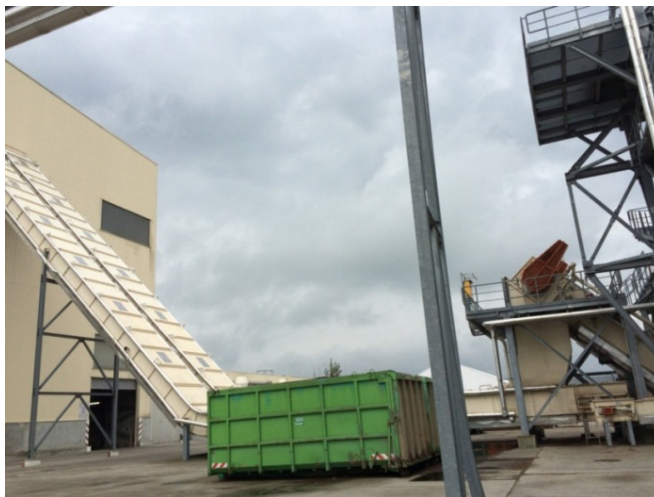
Figura 3.17. Banda transportoare cu aşchii adezivate (Autorul)
