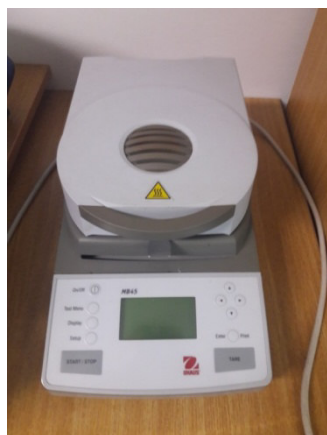
Figura 4.3. Termobalanță electronică – Laboratorul de Produse Forestiere (Autorul)
