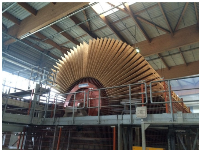
Figura 3.26. Răcirea plăcilor OSB în instalaţii de tip evantai (Autorul)
