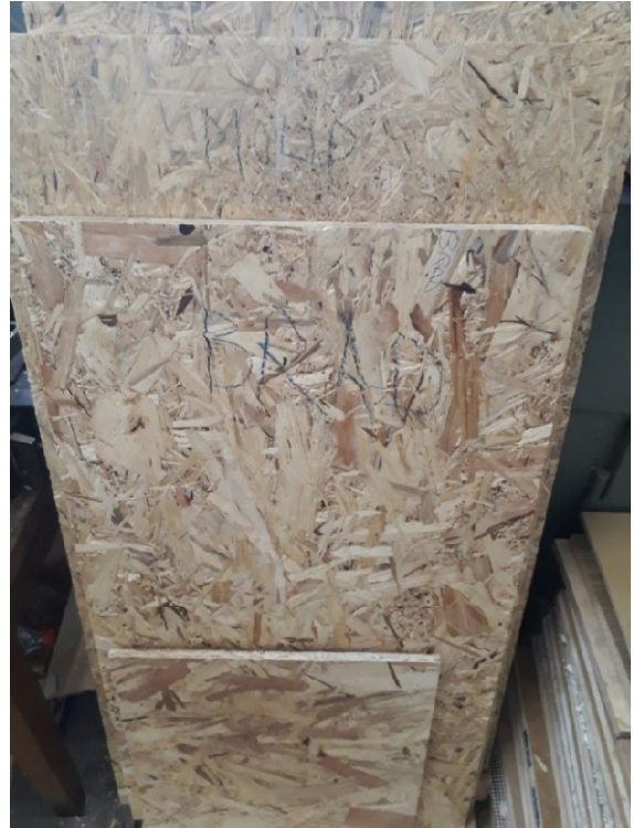
Figura 3.38. Plăci OSB din amestec (brad, molid și pin – Autorul)
