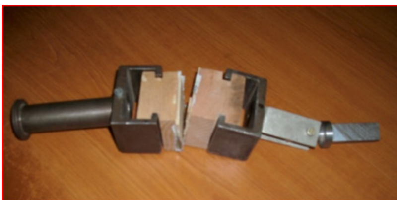
Figura 4.18. Determinarea rezistenţei la coeziune internă transversală (Lunguleasa 2004b)
