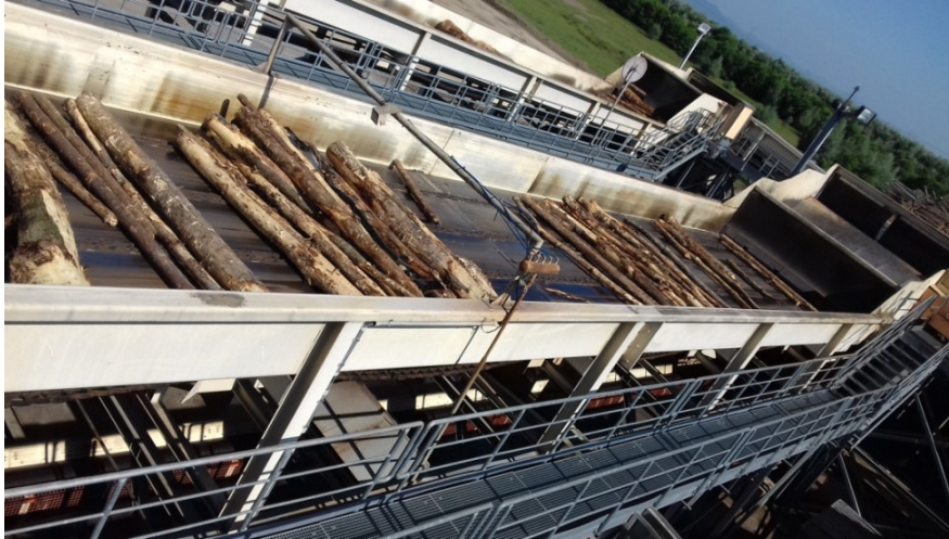
Figura 3.6. Alimentarea unui cojitor (Autorul)
