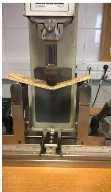
Figura 4.6. Epruveta de OSB testată la încovoiere statică pe maşina universală IMAL IB 600 (Autorul)
