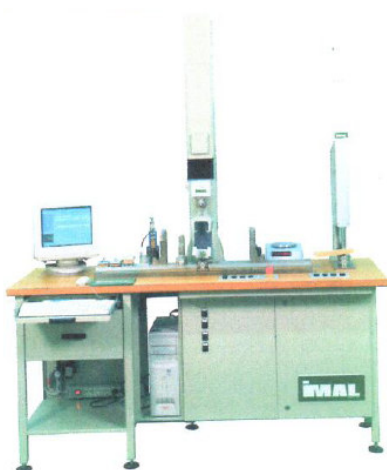
Figura 4.1. Mașina universală de încercat IMAL IB 600
