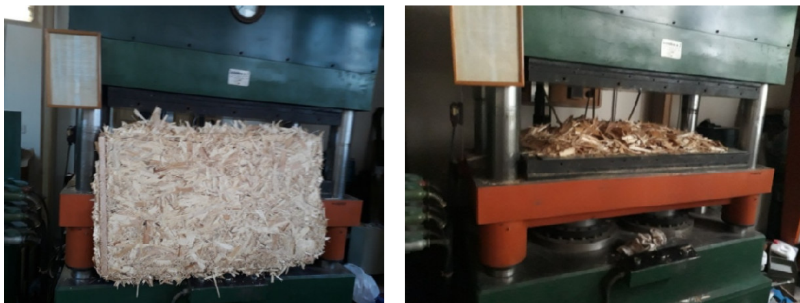
Figura 3.36. Presa hidraulică numărul 1, covorul și placa OSB corespunzătoare (Autorul)
