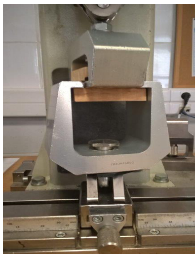
Figura 4.20. Determinarea coeziunii interne a plăcilor OSB (Autorul)
