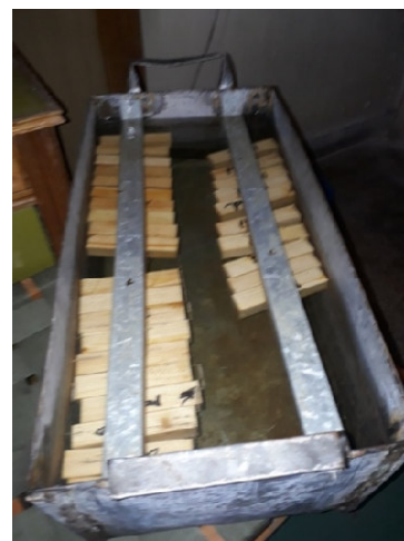
Figura 4.2. Menținerea epruvetelor în baie de apă – Laboratorul de Compozite Stratificate (Autorul)
