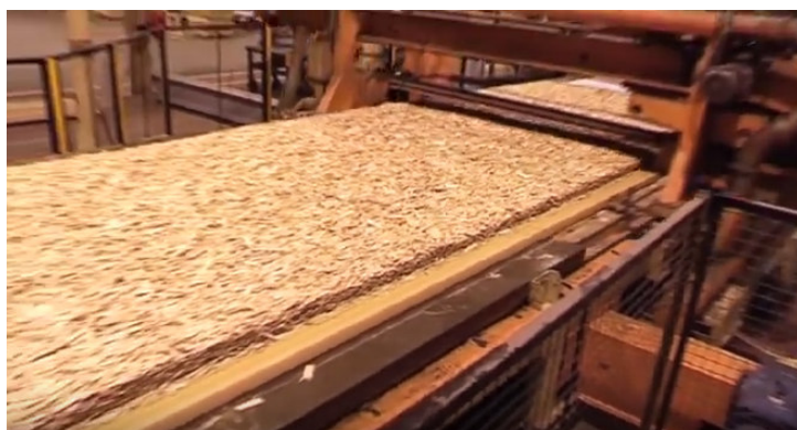
Figura 3.23. Covor de aşchii orientate, în zona de secţionare a acestora (Autorul)
