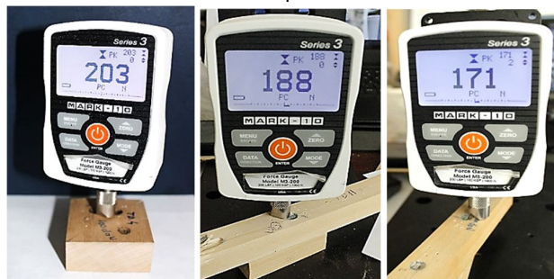
Fig 3.44 Determinarea durității HM, în proximitatea durității Brinell (Original LRCX)
