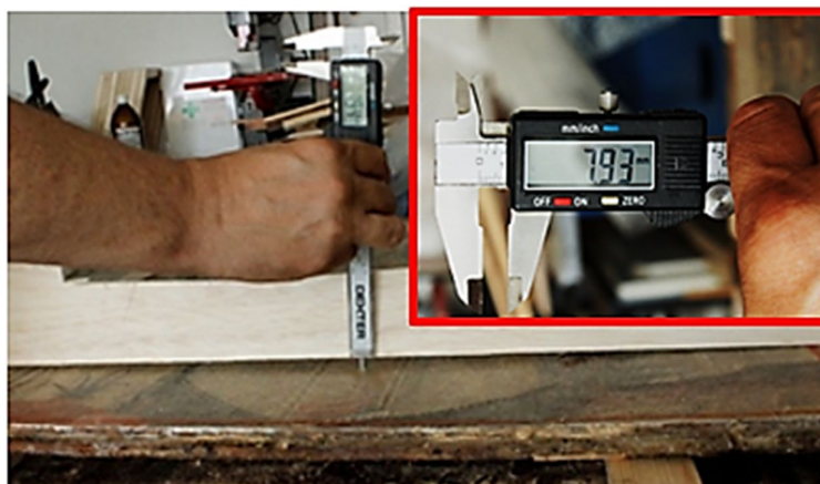
Fig. 4.23 curbarea panoului după tratamentul de consolidare B72 în Acetonă (Original LRCX)
