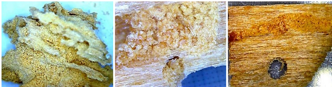
Fig. 4.11 Orificii și galerii cu fracții de lemn care blochează sau reduc eficiența unui tratament de consolidare. Mărire 20x, 40x (Original LRCX)
