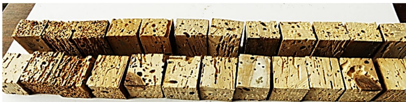
Fig. 4.21 Epruvetele supuse tratamentelor de consolidare
