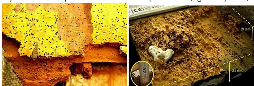
Fig. 3.19 Orificii și galerii larvare, în volumul lemnului (Original LRCX)
