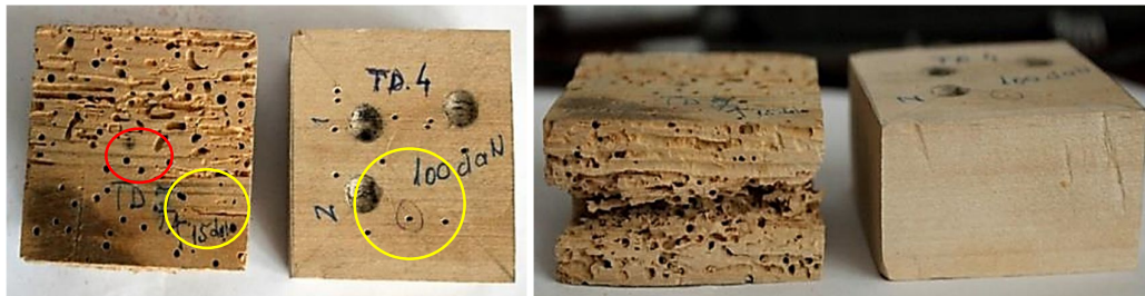
Fig. 3.47 Compararea lemnului de tei sănătos (TD4) cu cel foarte degradat (TD7), supus testărilor de duritate HB și HM (Original LRCX)
