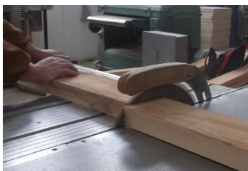
a) retezare – cu ferăstrăul circular
