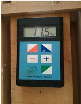
Fig.4.5. Măsurarea umidității (Țurcaș-Diaconu 2015)
