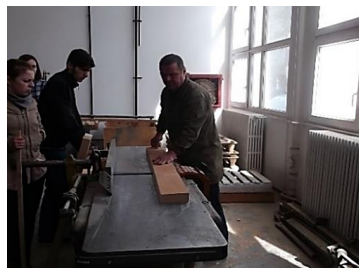
b) îndreptare față-cant – cu mașina de îndreptat;
