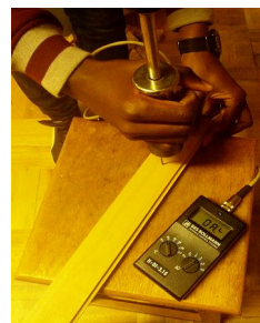
Fig.4.30. Măsurarea umidității cu BESS BOLLMANN
