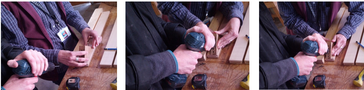
Fig.4.33. Executarea găurilor necesare amplasării traductorilor
