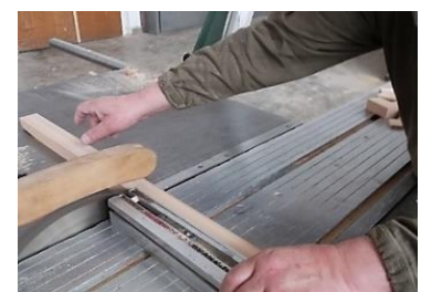
c) spintecare – cu ferăstrăul circular
