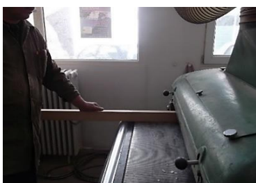
a) retezare – cu ferăstrăul circular pendulă
