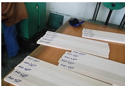
Fig.4.9. Epruvete tip A40 cu lungimi diferite pentru reazeme
