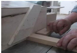
g). frezare uluc – cu mașina de frezat cu ax normal/vertical (M.N.F.); freza de 5 mm
