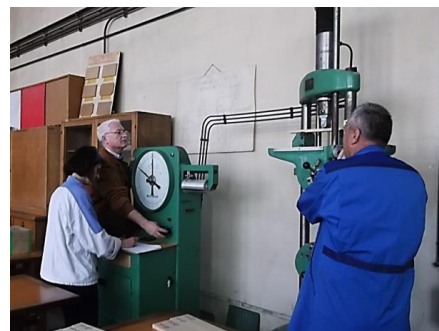
Fig.4.14. Continuarea ridicării epruvetei și citirea forțelor
