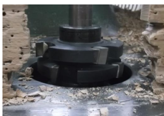
Fig.4.26. Mașina de frezat cu ax normal/vertical (M.N.F.-10) și capete port-cuțite de frezat (autorul)
