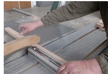
f) debitare la lungime – cu ferăstrăul circular
