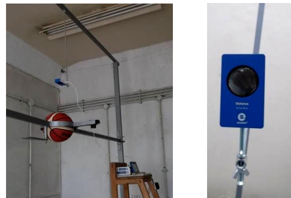
Fig.4.59. Fixare senzor de distanță
