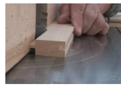
h). frezare lambă – cu mașina de frezat cu ax normal/vertical (M.N.F.); capete port-cuțite de frezat
