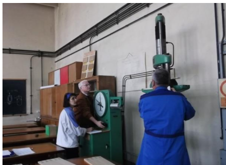
Fig.4.13. Ridicarea epruvetei (cu reazemele) până când săgeata w_1 = 2 mm
