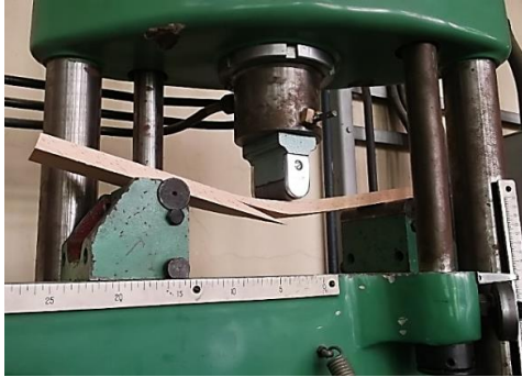
Fig.4.15. Solicitarea epruvetei până la rupere și citirea forței maxime la rupere (autorul)
