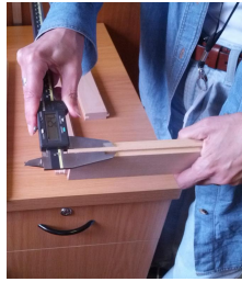
Fig.4.27. Măsurare cu ruleta și șublerul electronic
