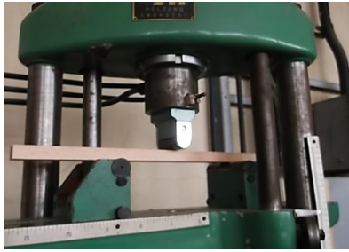
Fig.4.11. Așezarea epruvetei simetric față de reazeme
