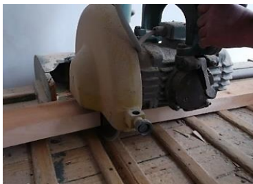
a) retezare – cu ferăstrăul circular pendulă
