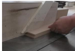
g). frezare uluc – cu mașina de frezat cu ax normal/vertical (M.N.F.); freza de 5 mm
