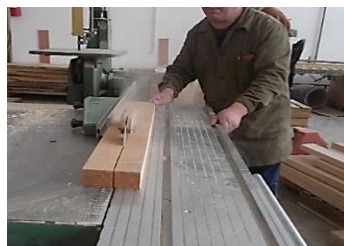
b) spintecare – cu ferăstrăul circular
