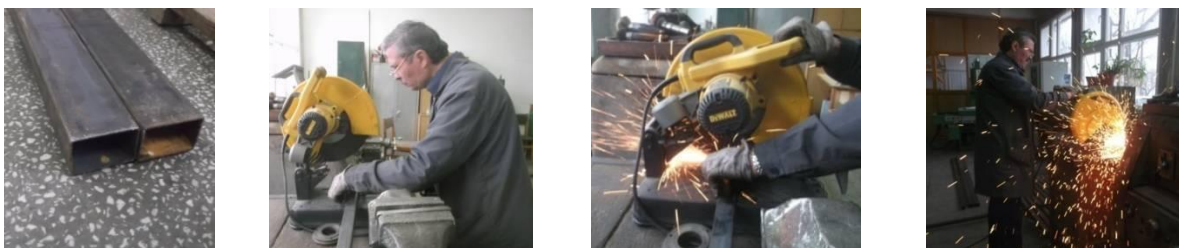
Fig.4.53. Pregătirea componentelor - țevă stâlpi 60x40x2
