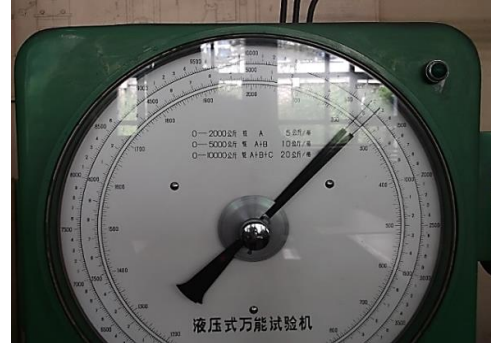
Fig.4.16. Ecranul mașinii de încercări, cu cele trei scale de lucru (autorul)
