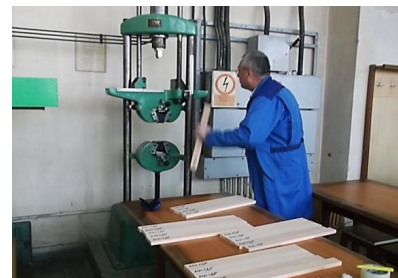
Fig.4.10. Reglarea distanței dintre reazeme
