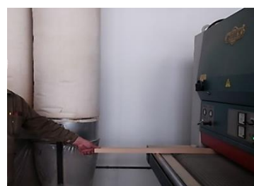
b) îndreptare față-cant – cu mașina de îndreptat;
