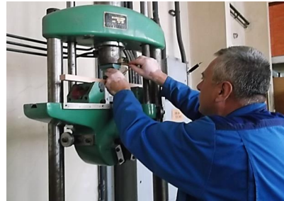
Fig.4.12. Reglarea poziției poansonului perpendicular pe lungimea epruvetei
