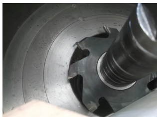
Fig.4.25. Mașina de frezat cu ax normal/vertical (M.N.F.-10) cu o freza de 5 mm (autorul)
