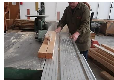
c) spintecare – cu ferăstrăul circular
