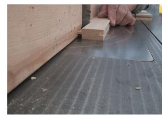
Fig.4.26. Mașina de frezat cu ax normal/vertical (M.N.F.-10) și capete port-cuțite de frezat (autorul)
