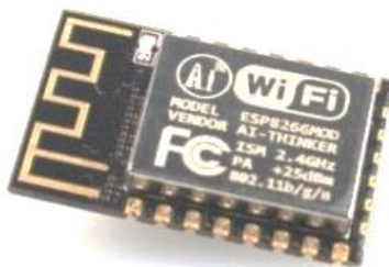
Figura 29: Exemplu de modul tip 12 de la AI THINKER (se observă antena pe cablaj imprimat)
