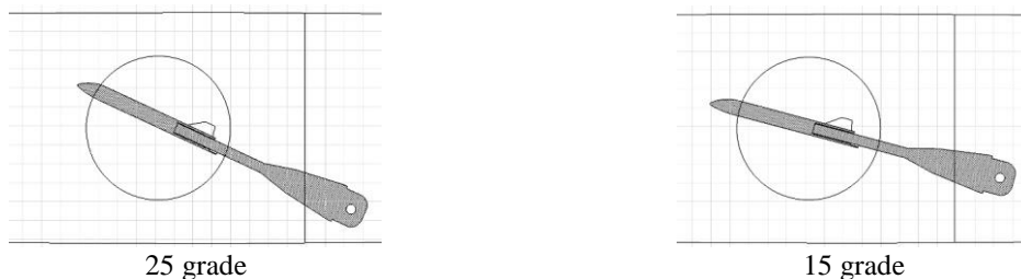
Fig. 4.27 Amplasarea machetei în raport cu fereastra Schlieren
