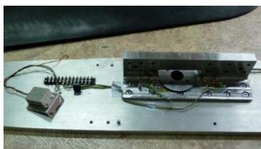
Fig. 3.42 Adaptorul “T” al aripii și plasarea mărcilor tensometrice
