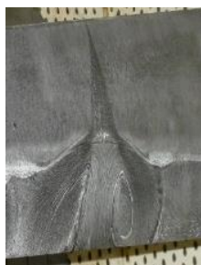
Fig. 3.66 Interacțiune incluziune turbulentă – undă de șoc oblică
