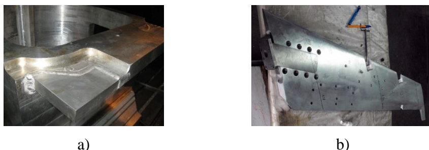
Fig. 5.24 Remediere defect, inserție asamblată cu pană și sudură a), stabilizator b)
