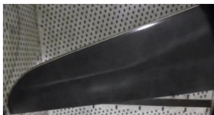
Fig. 3.59 Amprenta unei unde de șoc cu fixarea tranziției
