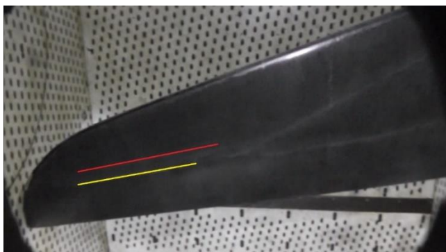
Fig. 3.61 Schimbarea bruscă a momentului de încovoiere la încastrare la dezlipirea benzii de fixare tranziție
