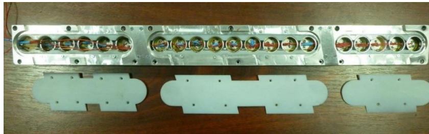
Fig. 3.50 Inserția cu maticile de actuatori SJ, bușele de montare presate, cablajul și capacele conforme pe suprafața de intrados a aripii
