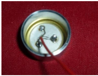
Fig. 3.47 Cositorirea în trei puncte a conductorului pe membrană
