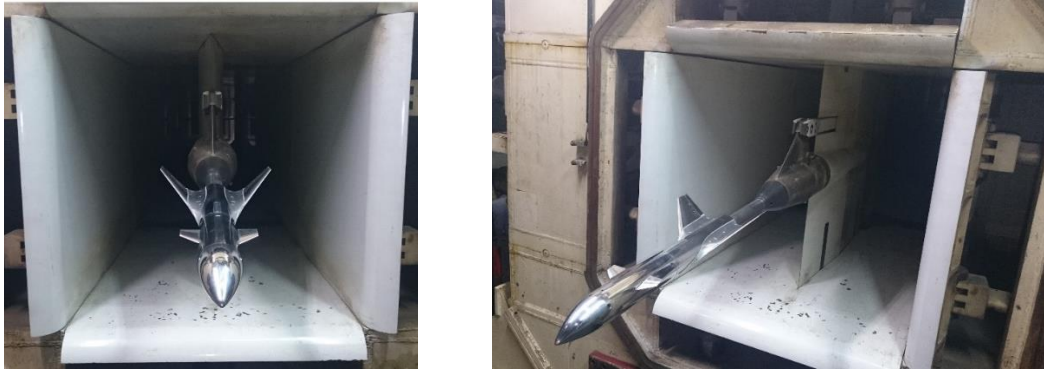
Fig. 4.28 Modelul Glide Back Booster instalat pe sting
