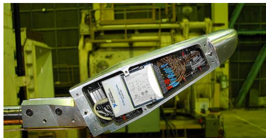
Fig. 4.17 Instrumentarea și instalarea machetei lifting body
