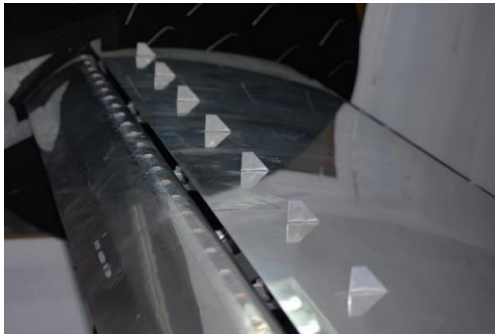
Fig. 3.7 Generatoarele de vârtej MVG1 și MVG2
