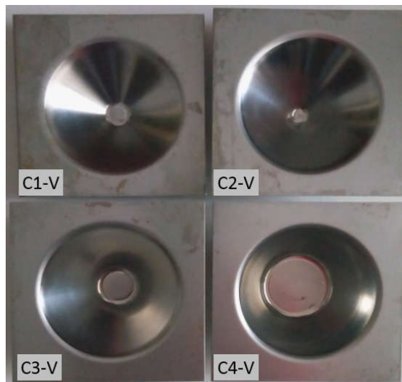
Figura 5.14 Cele patru piese deformate pentru validarea rezultatelor analizelor de regresie
