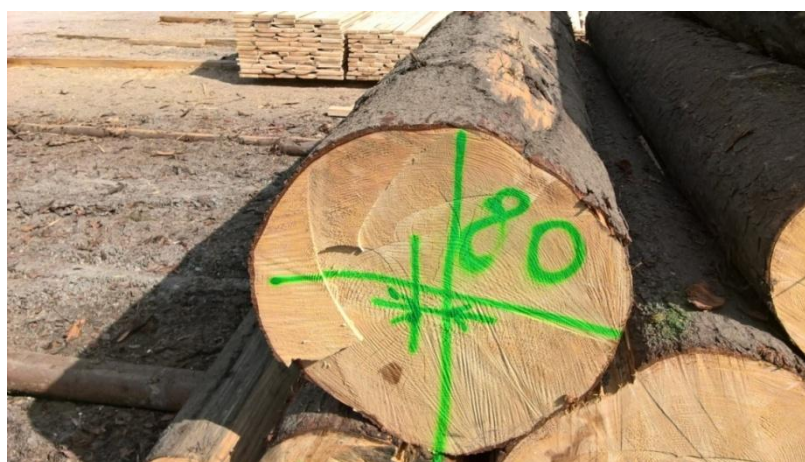
Fig. 63. Buștean cu excentricitate puternică, din u.a. 33C la Kedves Import Export S.R.L. (foto G. Molnár)
