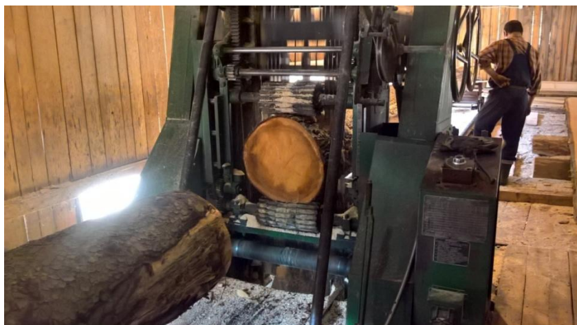
Fig. 80. Debitarea buştenilor de molid cu gaterul vertical la Tafcom S.R.L (Foto G. Molnár)
