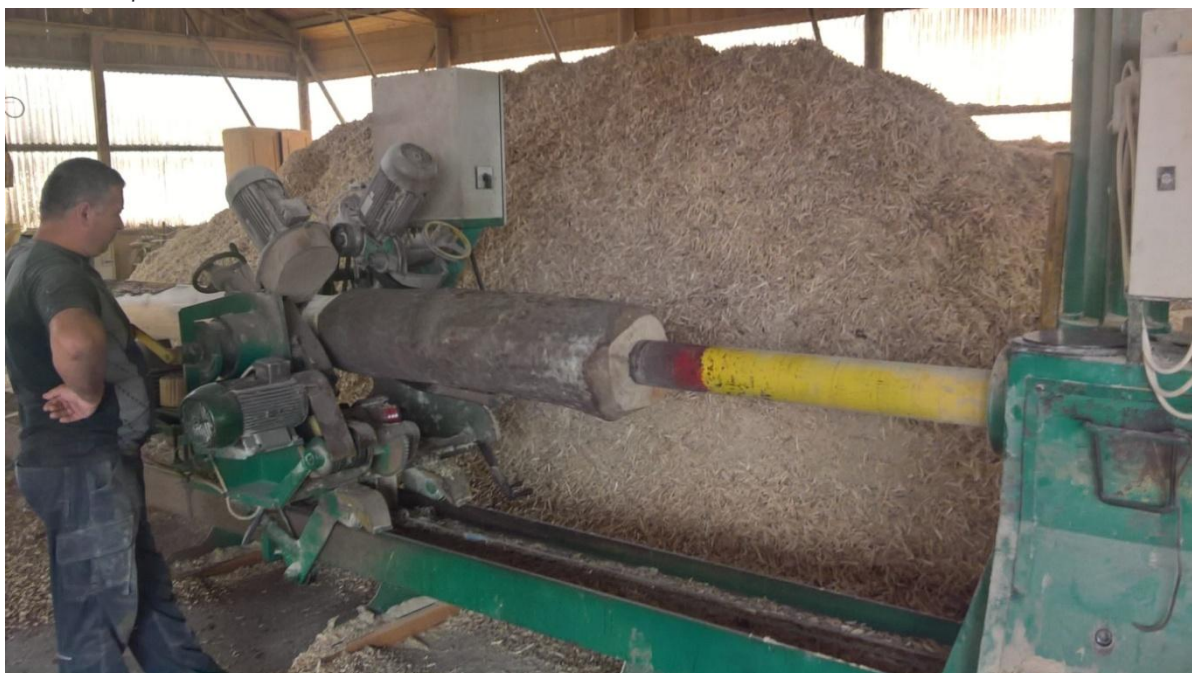
Fig. 87. Strung de calibrat buşteni de răşinoase la PALPRODEX S.R.L. (foto G. Molnár)
