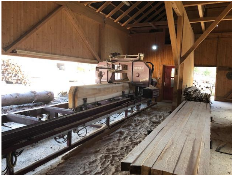
Fig. 78. Fierăstrău panglică vertical pentru debitarea buştenilor de molid la Kedves Import Export S.R.L. (foto G. Molnár)
