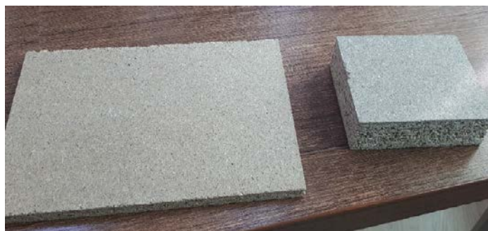
Fig. 4.14. Diferența de suprafață între 100g de placă, pentru plăci cu grosimea de 8mm și respectiv 28mm.
