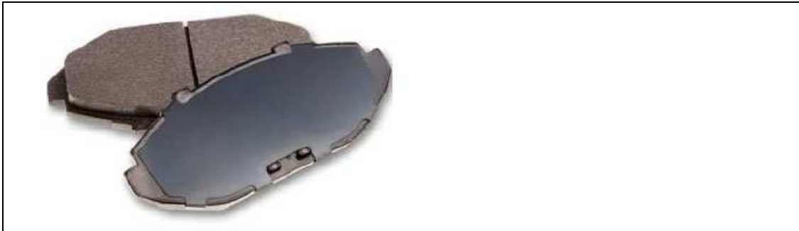
Fig. 6-20 – Ilustrarea unui shim asamblat mecanic pe spatele unei plăcuțe
