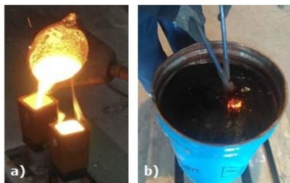
Figura 9. Experimente de solidificare întreruptă: a) cupe de analiză termică; b) răcire rapidă în saramură.
