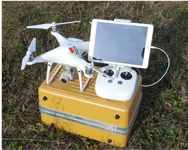
Fig. 2.5. UAV-ul DJI Phantom 4 PRO și cu dotările acestuia UAV DJI Phantom 4 PRO with its facilities
