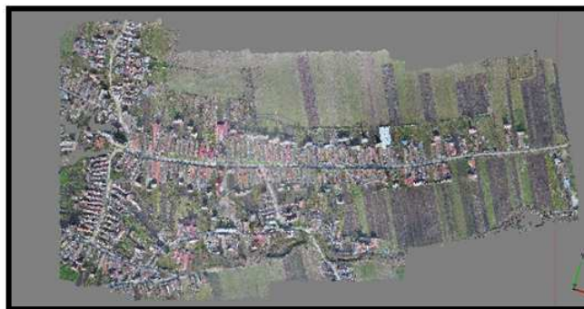
Fig. 5.26. Norul rar de puncte obținut în urma procesului de aliniere al imaginilor Sparse point cloud obtained following the alignment of images
