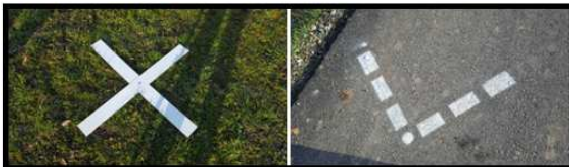
(a) (b) Fig. 5.8. Semnalizarea reperilor fotogrammetrici: a – în fond agricol; b – pe asfalt Markings used for GCPs: a – in agricultural fond; b – on asphalt
