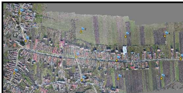
Fig. 5.27. Poziția reperilor fotogrammetrici redată pe norul inițial de puncte Position of GCPs given of the initial point cloud
