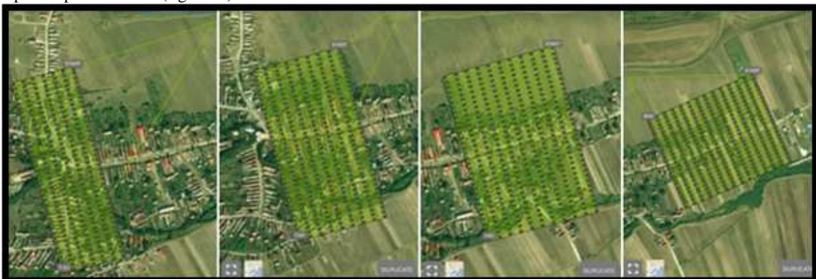
Fig. 5.21. Traseul liniilor de zbor proiectate cu programul PIX 4D suprapuse pe imaginea din Google Maps pentru zona studiată la Crizbav Flight paths designed by PIX 4D software overlapped on the image from Google Maps for the area studied in Crizbav
