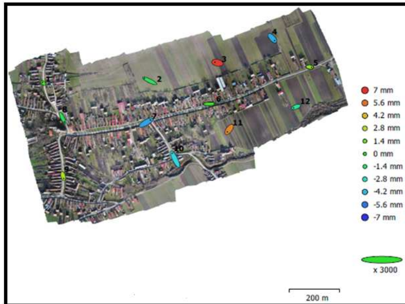
Fig. 5.34. Localizarea reperilor fotogrammetrici. Erorile pe axele X și Y sunt reprezentate de forma elipsei. Eroarea pe axa Z este reprezentată de culoarea elipsei. Estimarea locației reperului este marcată printr-un punct.
