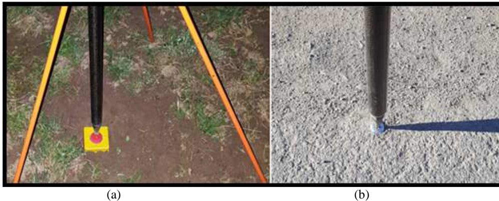
Fig. 5.1. Marcaje folosite pentru materializarea punctelor din rețeaua de sprijin și de ridicare a – borne de tip Feno; b – buloane metalice Markings used for the materialization of points for the support and raise network a – Feno bollard; b – metallic bolts
