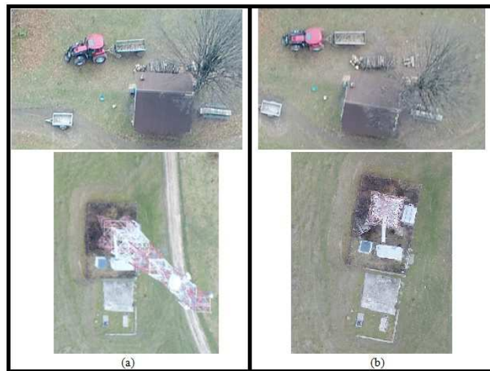
Fig. 6.8. Vederea laterală a obiectelor în imaginea neprelucrată (a) și vederea ortogonală a aceluiași detalii pe ortofotoplan (b)
