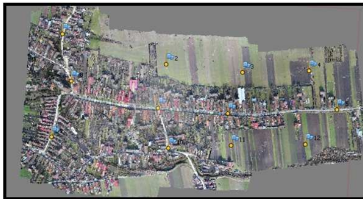
Fig. 5.29. Norul dens de puncte obținut prin îndesirea norului rar Dense point cloud obtained through thickening the sparse cloud
