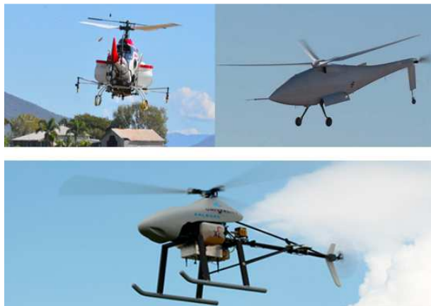
Fig. 3.1. Tipuri de UAV-uri uni-rotor realizate în diferite forme constructoare Types of unicopter UAV made in different construction forms
