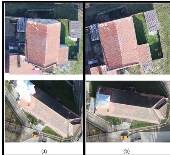
Fig. 5.32. Vederea laterală a obiectelor în imaginea neprelucrată (a) și vederea ortogonală a aceluiași detalii pe ortofotoplan (b)
