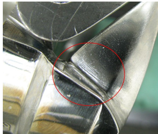
Figura 2.6 Urme adânci de uzură lăstate de firul de ață pe ciocul graiferului
