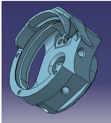
Figura 2.4 Corpul graiferului rotativ
