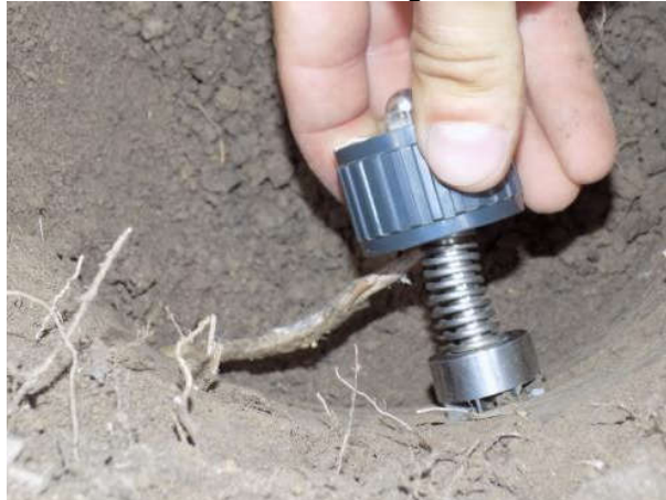
Fig. 3.6 Măsurarea rezistenței la forfecare pe pereții gropii
