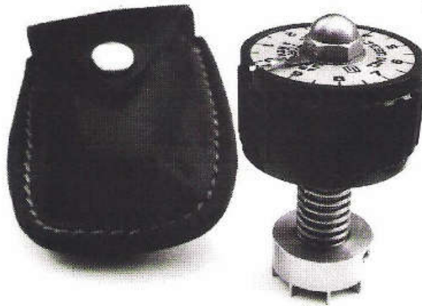
Fig. 3.5 Aparat pentru măsurarea rezistenței la forfecare a solului (Popescu I., et. al 2000)
