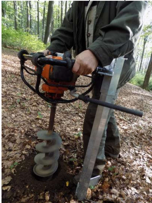
Fig. 5.1 Sistem de siguranţă a muncitorului montat pe cadru Fig. 5.1 Worker safety system installed on the drill
