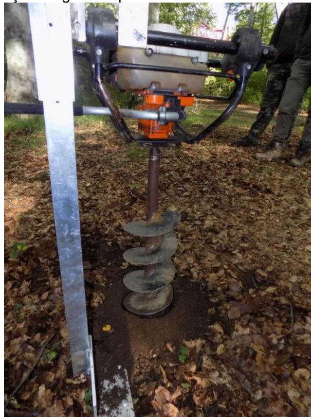
Fig. 5.3 Culisarea sistemului de siguranță în timpul lucrului Fig. 5.3 Sliding the worker safety system during operation
