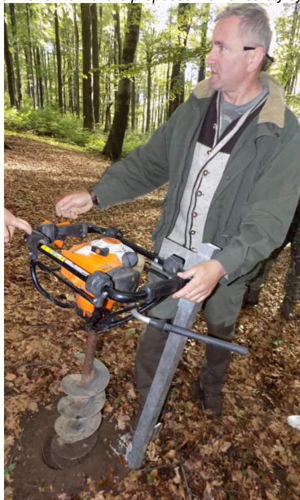
Fig. 5.5 Pregătirea motoburghiului și a sistemului de siguranță pentru lucru Fig. 5.5 Preparing the drill and the worker safety system for operation
