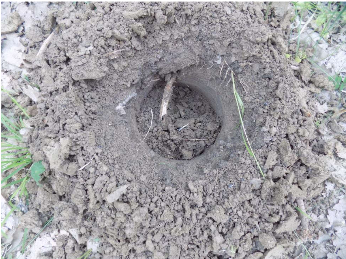
Fig. 5.13 Imposibilitatea forării gropii datorită tasării solului Fig. 5.13 Impossibility of hole execution due to soil compression
