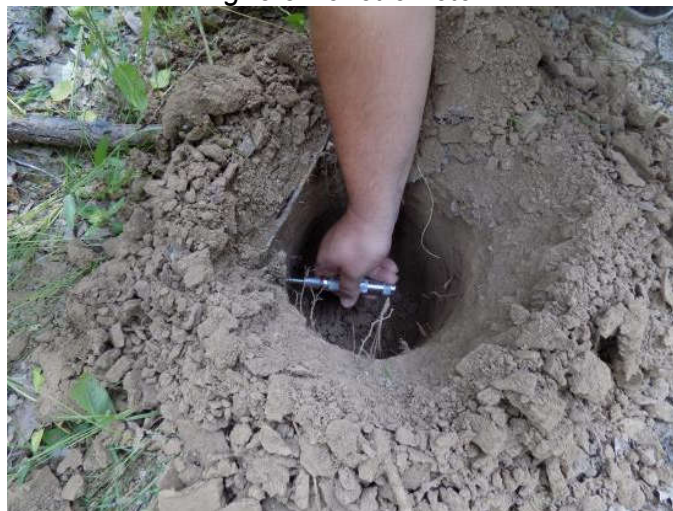
Fig. 3.4 Măsurarea rezistenței la penetrare la diferite adâncimi Fig. 3.4 Measuring penetration resistance at different depths
