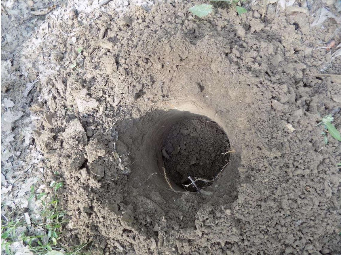
Fig. 5.12 Tasare exagerată a pereţii gropii în câmpul experimental 9 Fig. 5.12 Over-compression of the hole walls in experimental field 9
