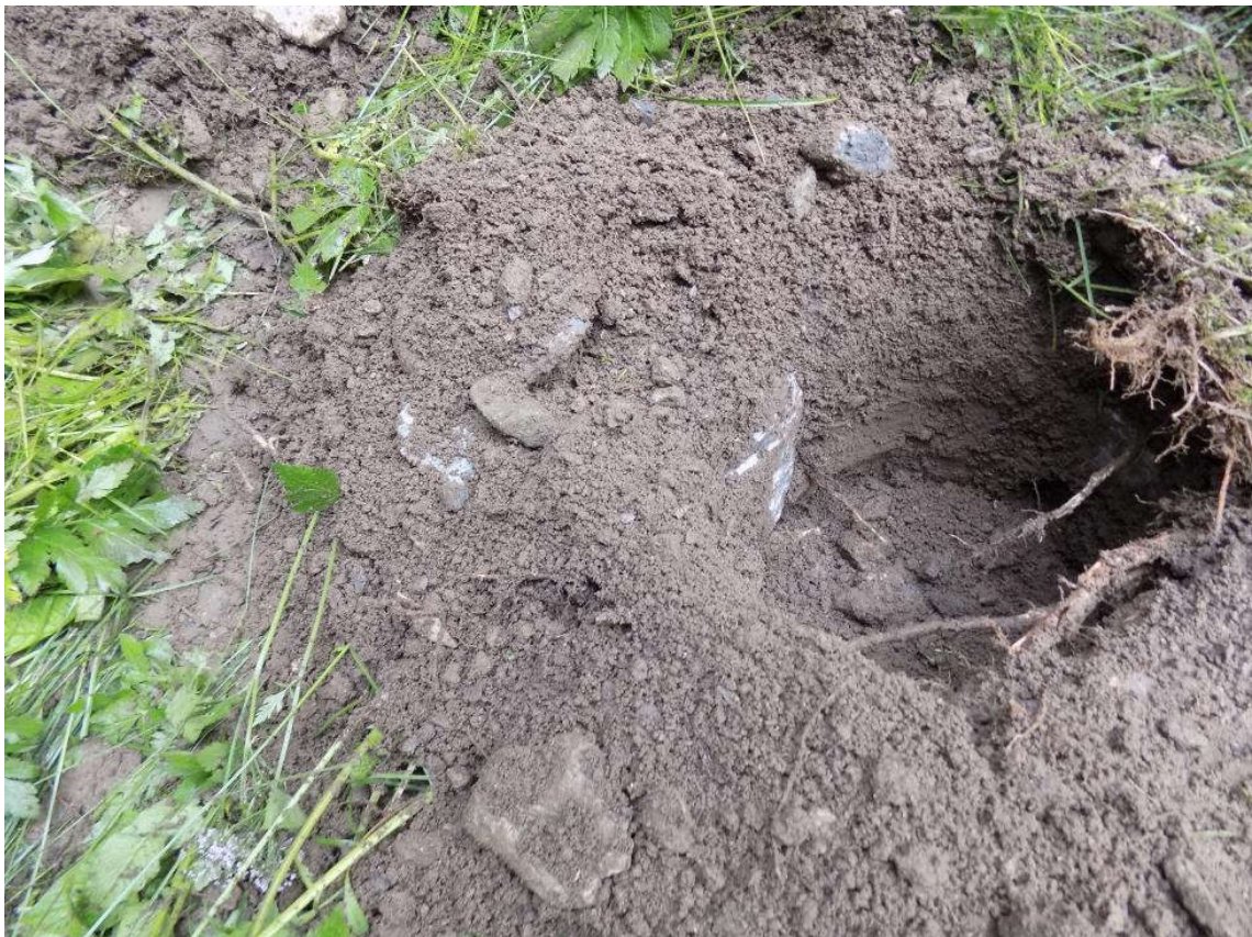
Fig. 5.15 Imposibilitatea forării gropii datorită materialului parental de la suprafață Fig. 5.15 Impossibility of hole execution due to surface material
