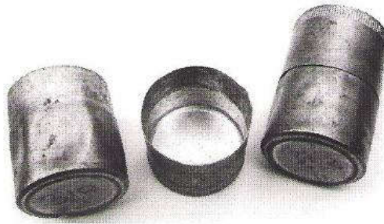
Fig. 3.1 Cilindrii de metal pentru prelevarea probelor de sol în vederea determinării proprietăților fizice
