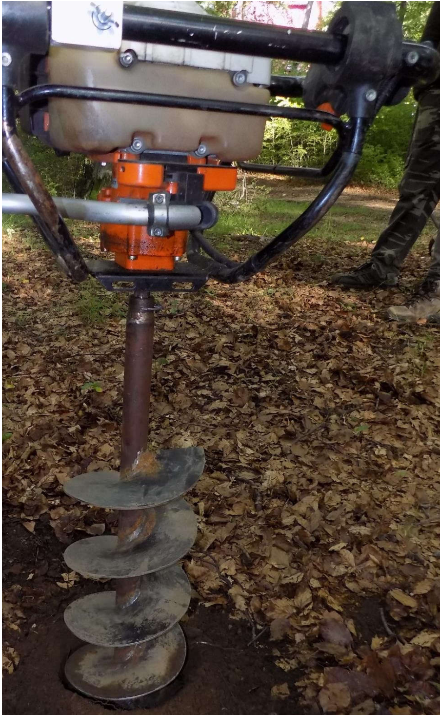
Fig. 5.6 Burghiu cu diametrul de 30 cm Fig. 5.6 Drill with a 30 cm diameter
