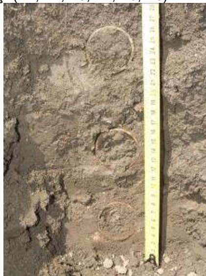
Fig. 3.2 Amplasarea inelelor de prelevare pe diferite trepte de adâncime Fig. 3.2 The placement of depth-setting rings on different depth levels
