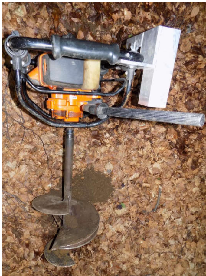
Fig. 5.7 Burghiu pentru execuția gropilor cu cavitați Fig. 5.7 Drill used in drilling cavity holes
