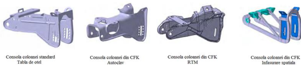
Figura 2.14: Desen CAD- consola coloanei de direcție în funcție de procesul de fabricație [32]
