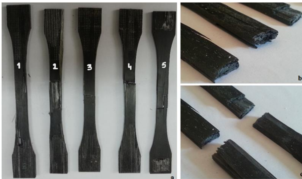
Figura 4.3: Epruvete (Sigrafil C30) după testarea la tracțiune (a), tipuri de rupere a epruvetelor (b) și delaminarea epruvetelor la tracțiune (c)
