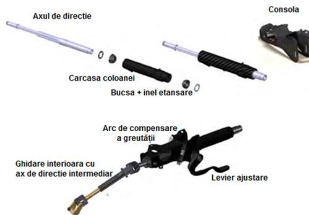
Figura 2.12: Componente din materiale compozite în structura coloanei de direcție
