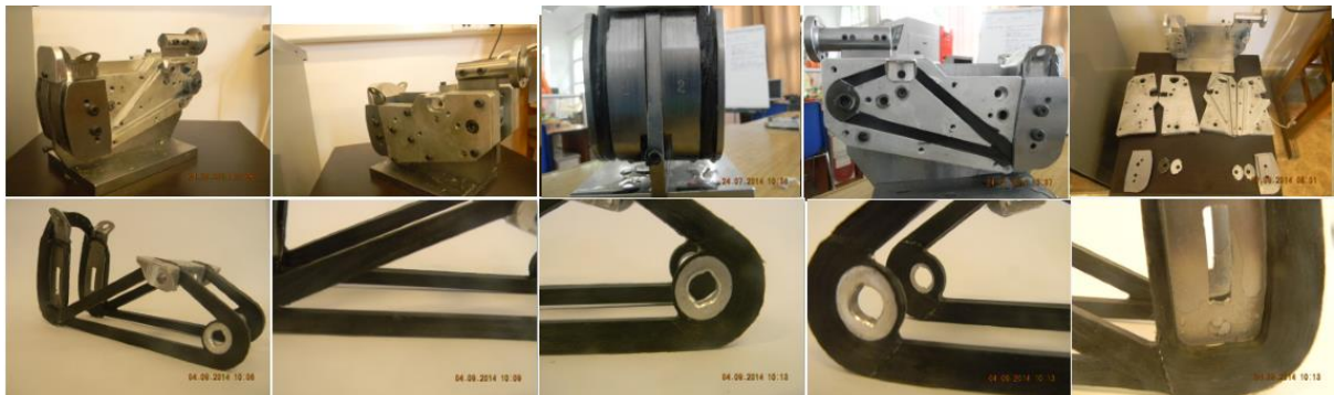
Figura 5.7: Defectele coloanei de direcție versiunea V3-matrița cu plăci de presiune
