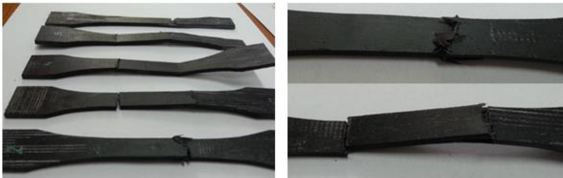
Figura 4.7: Ruperea epruvetelor pe baza de Sigrafil C30 la compresiune și cele două tipuri de rupere apărute (rupere tip forfecare respectiv rupere prin flambaj)
