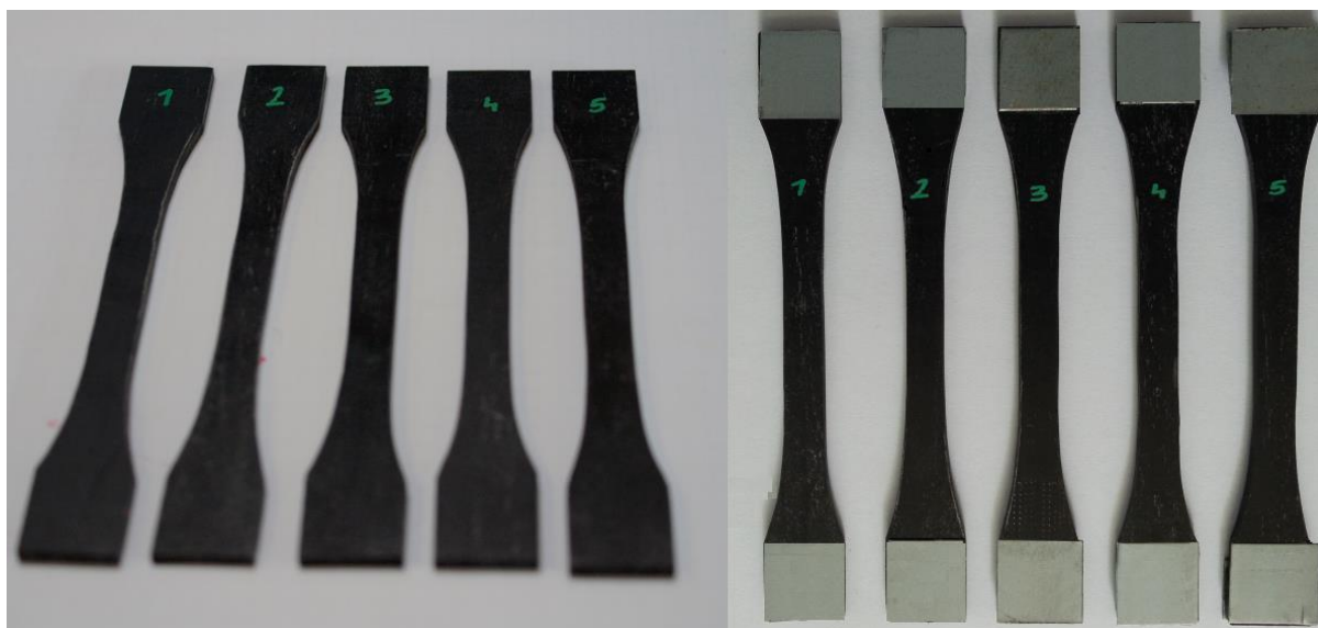
Figura 4.5 Epruvete categoria I înainte și după aplicarea taloanelor foi metalice
