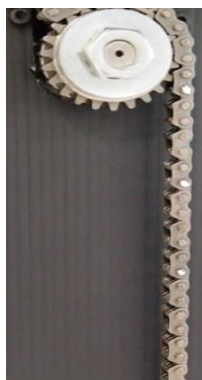
Fig. 3.33 Pendulul analogic al lui Huygens – instalare parțială
