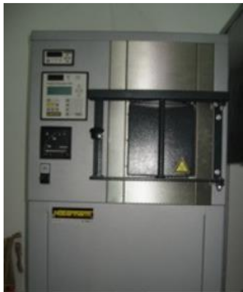
Figura 3.8. Cuptor pentru temperaturi înalte Nabertherm HT 16/16
