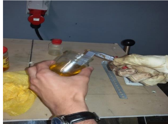
Figura 3.6. Modul de decapare chimică cu soluție de HCl Figura 3.7. Decapare chimică utilizând apă tare
