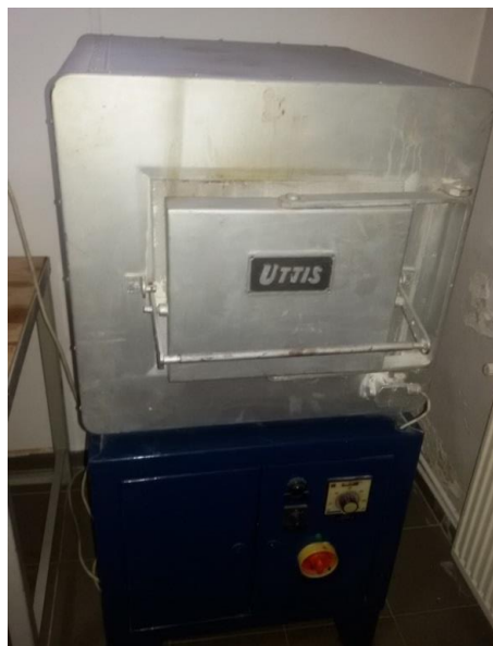
Figura 3.2. Cuptor de elaborare cu rezistență pentru topirea prealiajul Zn-Al și Zn-Al-5Ti-1B
