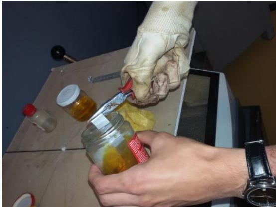
Figura 3.6. Modul de decapare chimică cu soluție de HCl Figura 3.7. Decapare chimică utilizând apă tare
