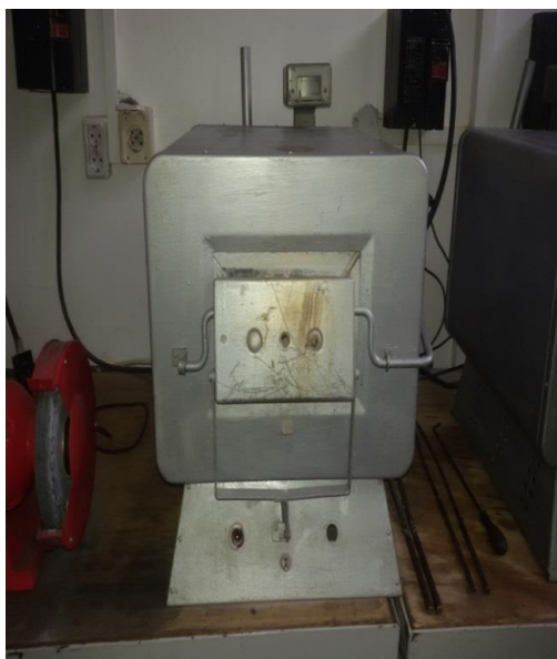
Figura 3.1. Cuptor de elaborare cu rezistență pentru topirea zincului
