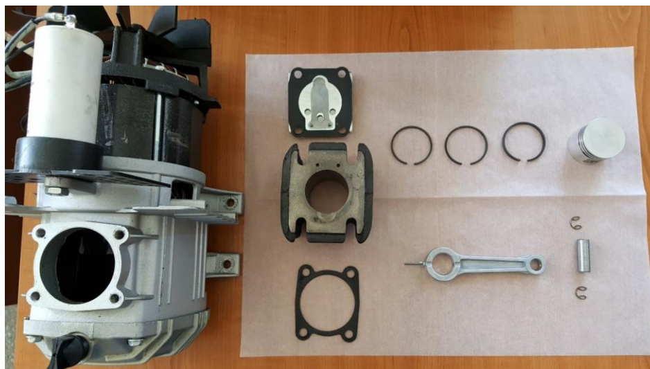
Figura 3.1 Elementele constructive ale compresorului mecanic cu piston "Black & Decker BD 205/24"
