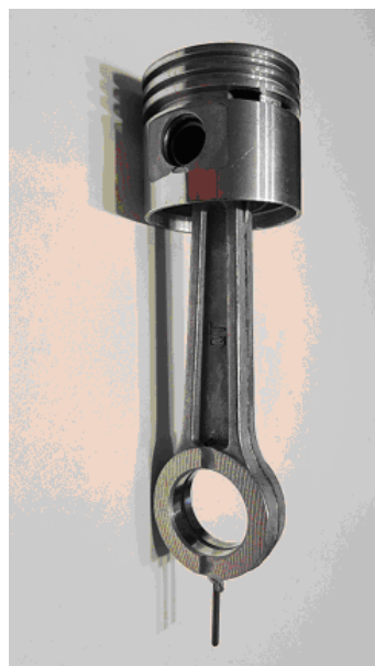
Figura 3.3 Pistonul montat pe bielă, cu agitatorul la baza bielei
