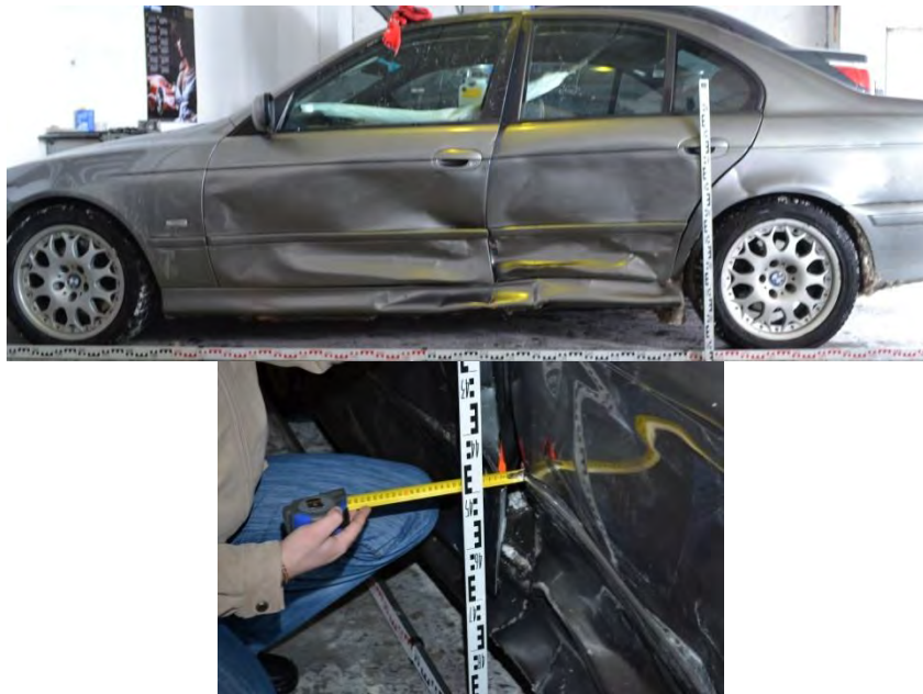
Fig. 2.29. Deformații ale autoturismului după coliziunea laterală
