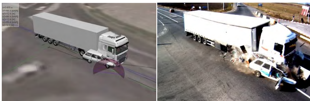
Fig. 2.15. Detaliu impact - simulare și cadru video
