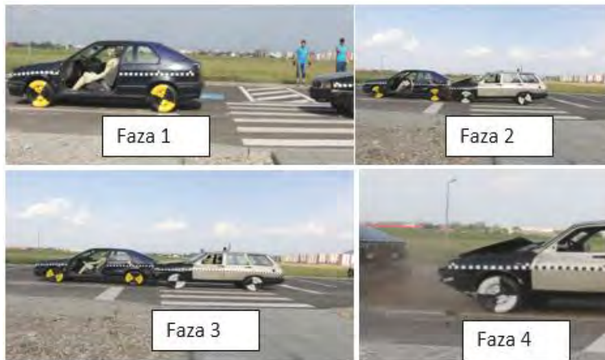
Fig. 5.10. Fazele coliziunii din testul experimental 3
