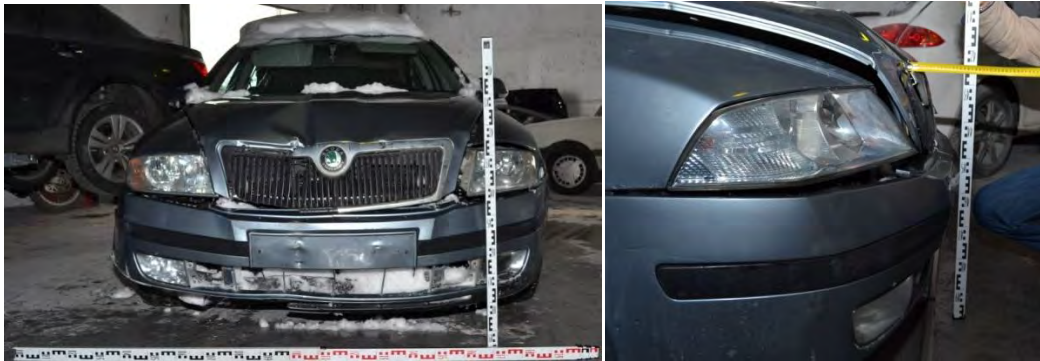
Fig. 2.30. Deformațiile autoturismului impactor
