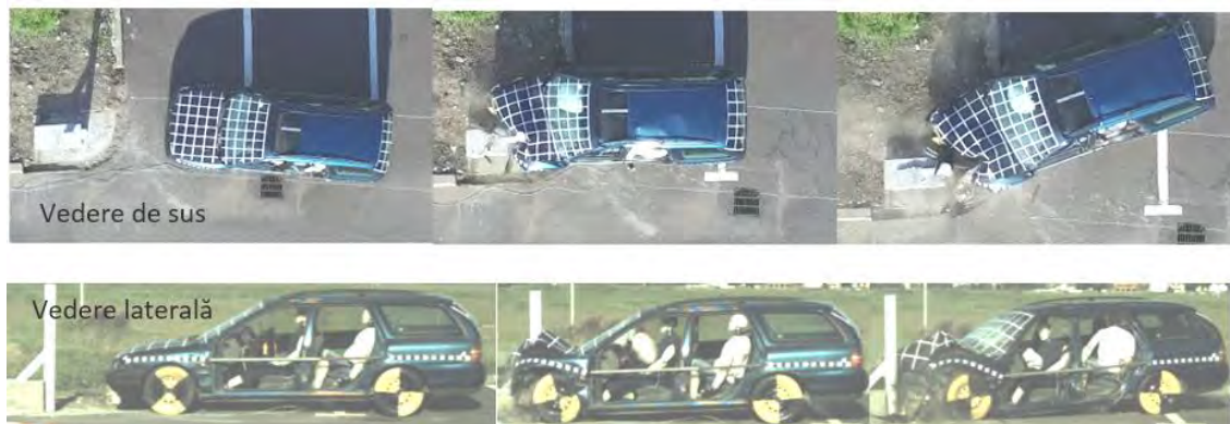
Fig. 5.5. Fazele coliziunii din testul experimental 1
