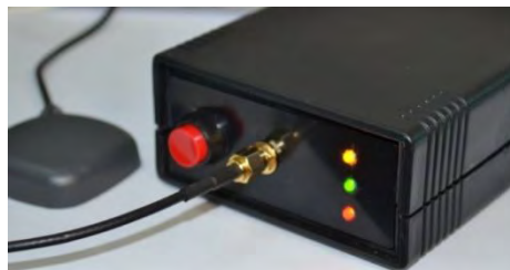
Fig. 4.3. Sistemul de achiziție a datelor DL-10, cu receptor GPS
