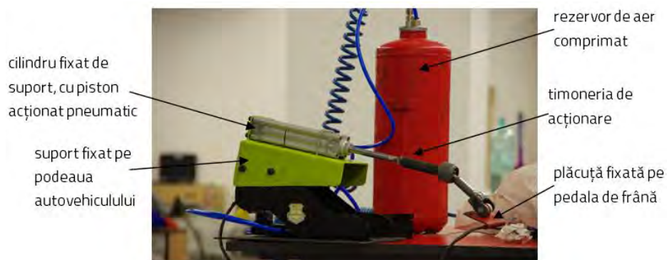
Fig. 5.3. Dispozitivul de acţiune a pedalei de frână
