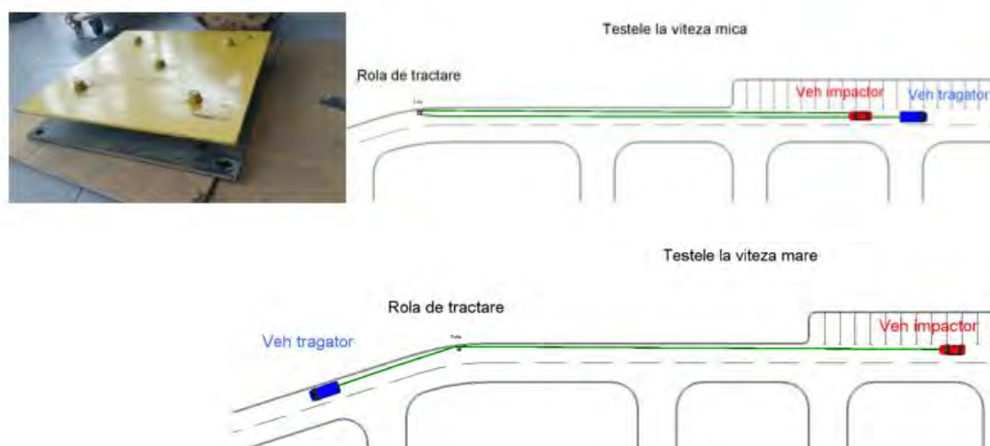
Fig. 5.1. Poziționarea și utilizarea rolei de tractare
