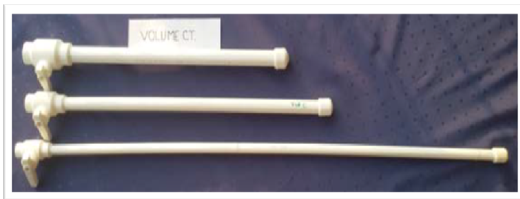
Fig. 3.25 Țevi PPR de diametre diferite și volum constant
