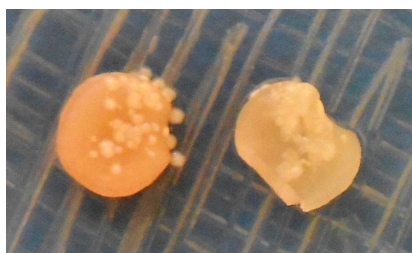
Fig.6.28 Colonii bacteriene dezvoltate pe suprafața PVA/Scl
