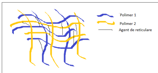
Fig.6.4 Structura unui hidrogel de tip IPN
