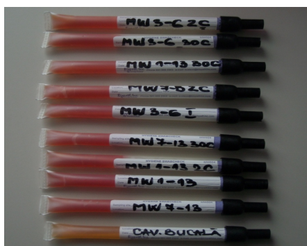
Fig.5.11 Rezultate obținute prin metoda SwabCheck pentru materialele cu matrice provenită din reciclarea deșeurilor plastice
