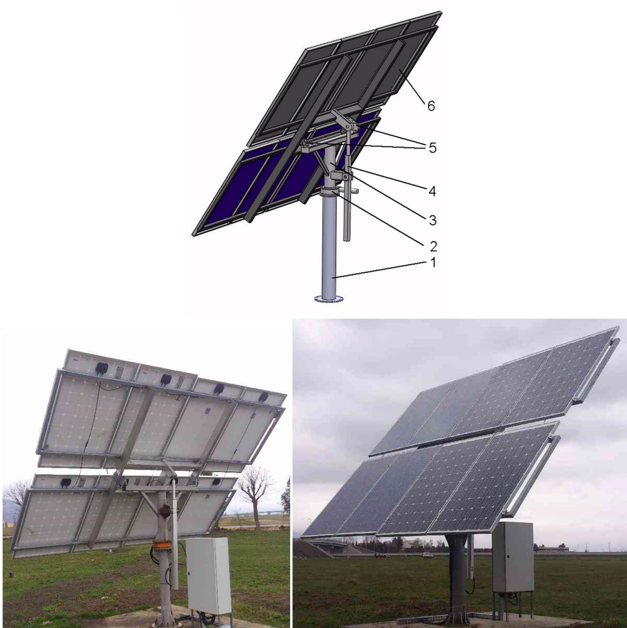
Fig. III.2. Sistem de orientare azimutal cu un actuator de rotație și un actuator liniar
