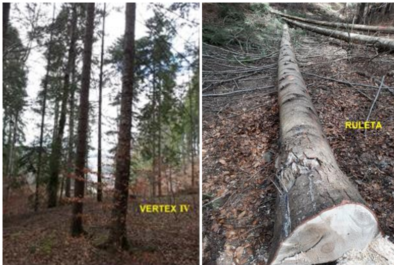
Figura 13. Materiale necesare pentru stabilirea în practică a erorilor care se înregistrează la măsurarea înălţimii arborilor cu Vertex IV – a) arbori pe picior şi Vertex IV; b) acelaşi lot de arbori doborâţi şi ruletă
