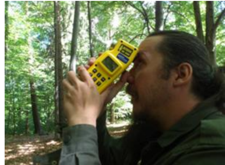
Figura 1. Măsurarea indirectă a diametrelor - a) cu ajutorul clupeii Mantax Black echipată cu Gator Eyes, produsă în Suedia; b) cu ajutorul dendrometrului Criterion RD 1000 produs în S.U.A.
