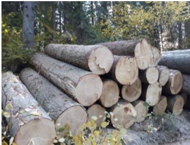
Figura 33. Piese de lemn rotund pentru care are aplicabilitate formula lui Huber – a) în varianta simplă; b) în varianta compusă
