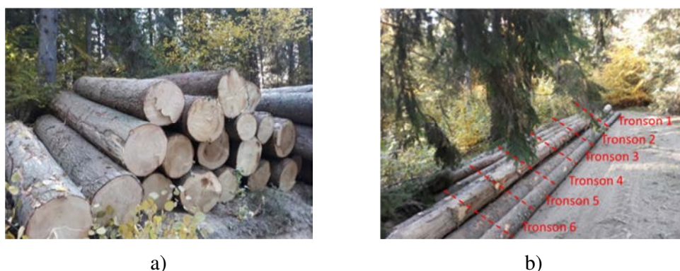
Figura 33. Piese de lemn rotund pentru care are aplicabilitate formula lui Huber – a) în varianta simplă; b) în varianta compusă
